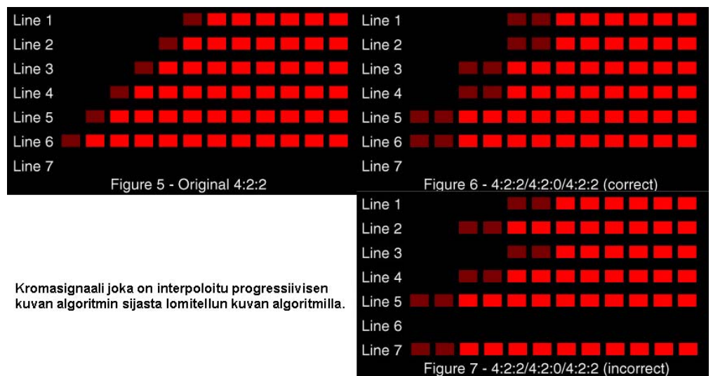
Kuva 12. Interpoloidun kromasignaalin vääristyminen
