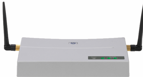
Kuva 24. ProCurve Wireless Access Point 420
