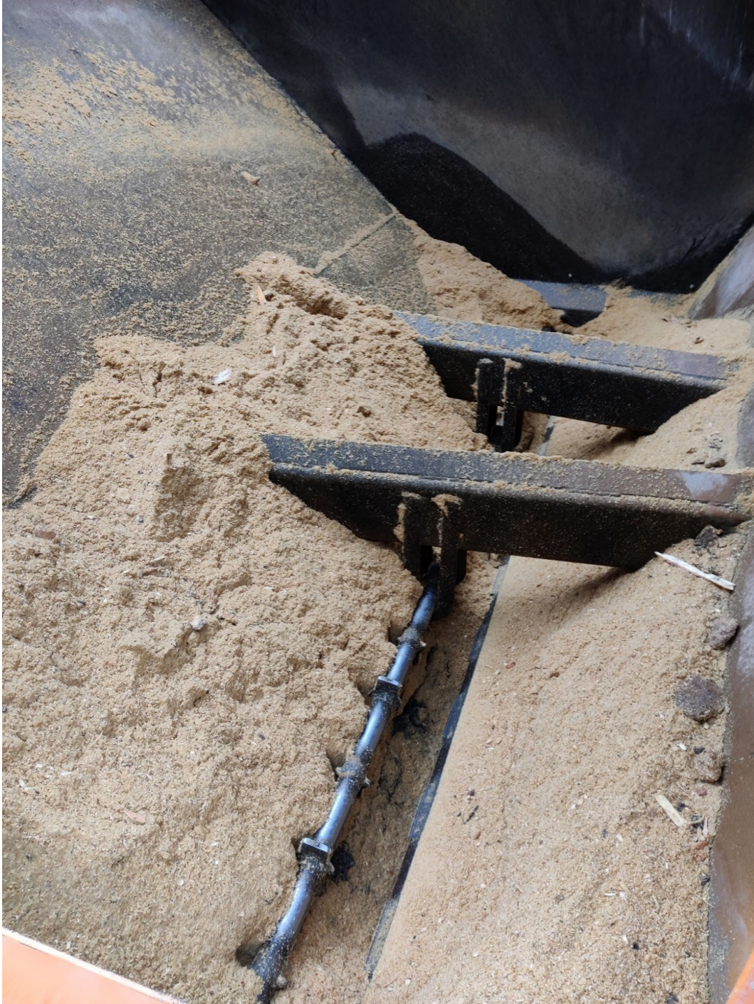
Kuva 13. Kuva hiekoitusvaunun siilosta, joka käytännössä tyhjä. Purun rippeitä siilon reunoilla.
