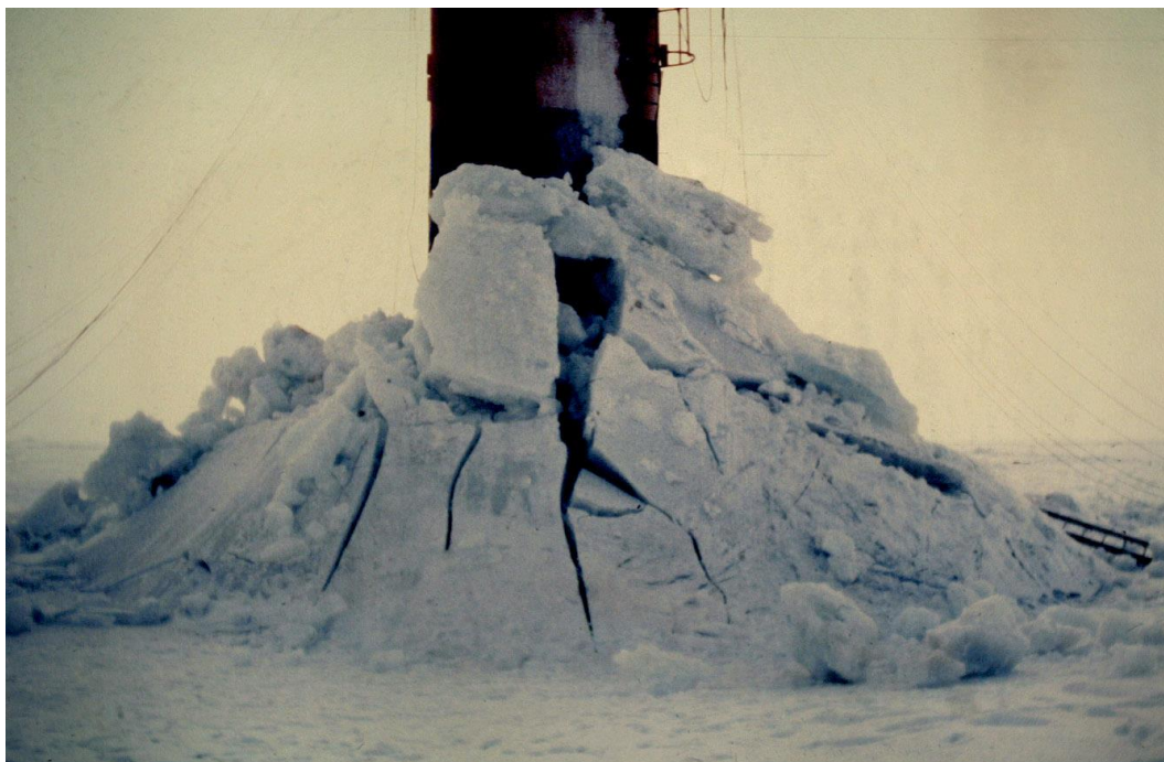
Kuva 18. Jään taivutusmurtuminen Kemi 1 kartiota vasten /18/.
