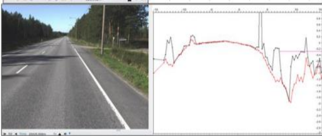
Kuva 4. Kahdella eri tavalla muodostettu poikkileikkaus samasta pistepilvestä. Kuvassa on esitetty katuvalon ja kasvillisuuden aiheuttamien virhepisteiden poistamiseen kehitetyn laskenta-algoritmin toimintaa. Musta viiva on normaali prosessoimaton poikkileikkaus ja punainen viiva prosessoitu.
