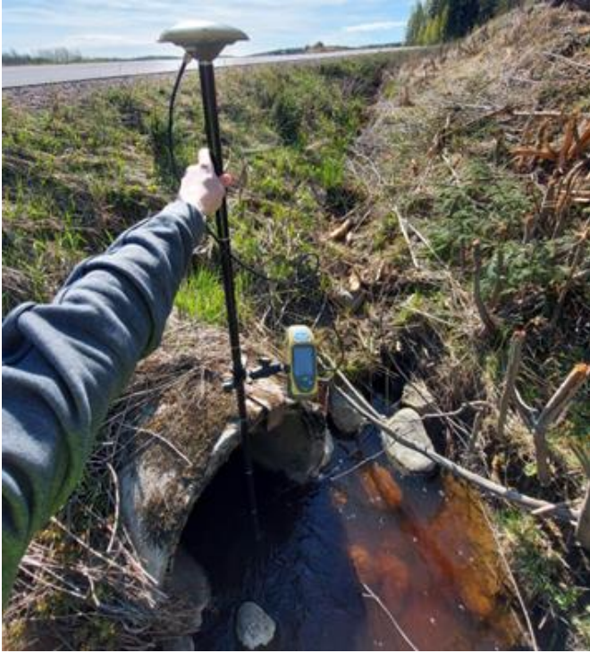
Kuva 8. Päätierummun korkeustason mittaaminen 11321 tiellä.
