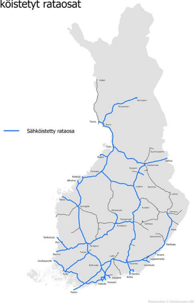
Kuva 14. Rataverkon sähköistystilanne. Sähköistettyihin rataosiin on sisällytetty myös rakenteilla olevat sähköistyskohteet.
