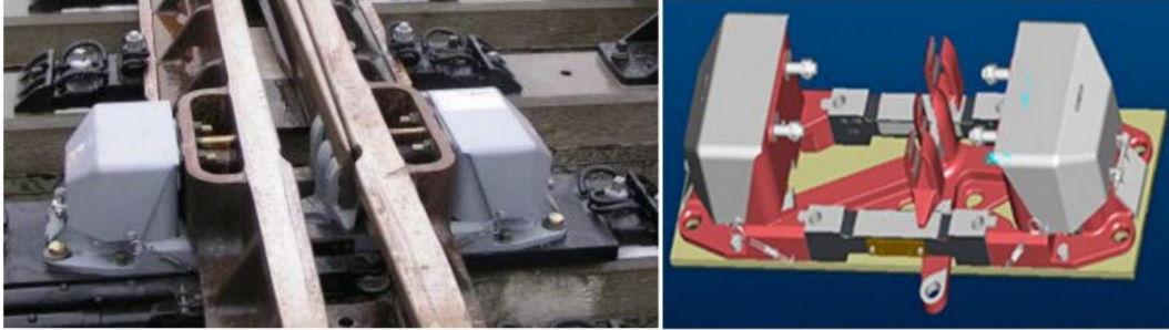
Kuva 12. Ranskassa käytettävä Vossloh-Cogiferin kääntö- ja lukitusmekanismi kääntyvän kärjen ensimmäisessä kääntöpisteessä. (Vossloh Cogifer 2017, Wang 2015)
