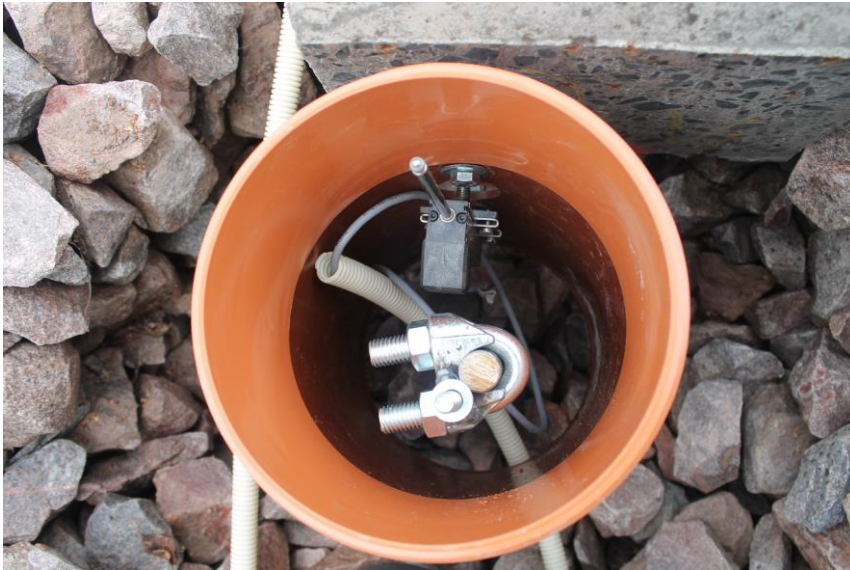
Kuva 31. Pölkyn pystysuuntaista liikettä mittaava anturi ja sen referenssitasona toimiva kairatanko kiinnikkeineen.
