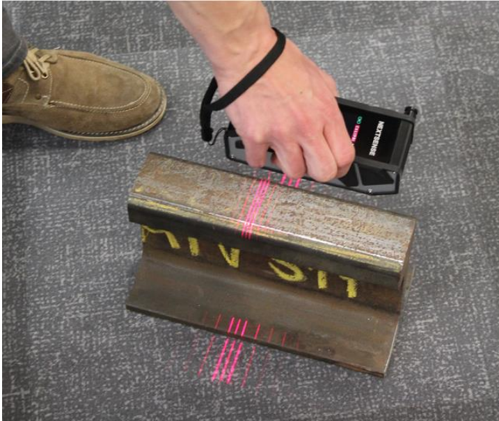
Kuva 42. Kosketuksettomaa laser-tekniikkaan perustuva kiskon poikkileikkausprofiilin mittaava Calipri-mittalaite.
