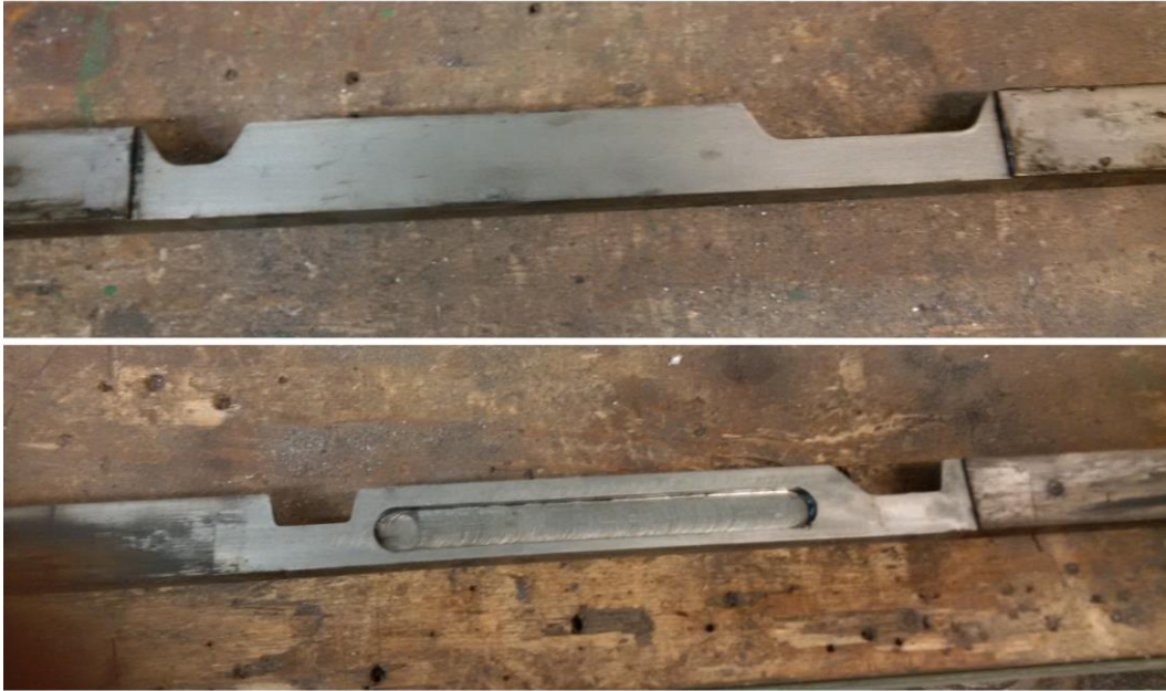
Kuva 37. Vaihteen tarkastustankojen muoto sormikoskettimellisen (yllä) ja rullakoskettimellisen (alla) mallin yhteydessä.
