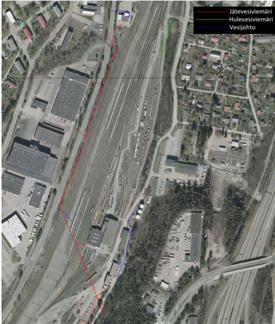
Kuva 2. Vesihuoltoverkosto (Tampereen vesi 2022, Maanmittauslaitoksen avoimena aineiston karttapalvelu 2022).
