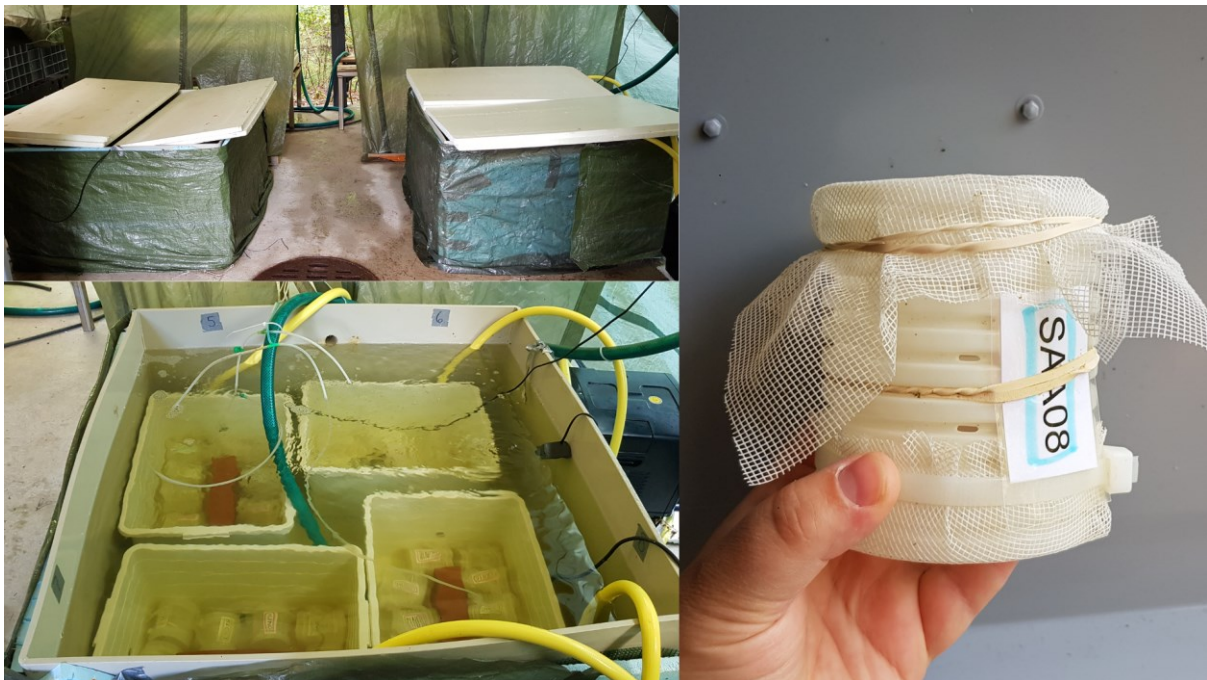
Figur 6. Uppe till vänster: de två isolerade vattenbaden. Nere till vänster: Överblick av det kalla vattenbadet, förvaringslådorna och förvaringsrören. Till höger: Förvaringsrör för krabba.
