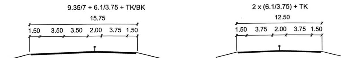
Kuva 16. Kaksiajorataisen keskikaiteellisen ohituskaistatien peruspoikkileikkaukset (2+1-kaistaa tai 1+1-kaistaa). Lähde: Tien poikkileikkauksen suunnittelu 21.12.2021, Väyläviraston ohjeita 16/2021.
