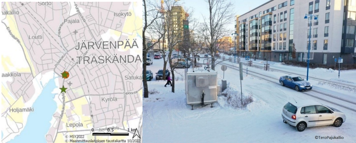
Kuva 8 a-b. Ilmanlaadun mittauspisteet Järvenpäässä vuonna 2022. a) kartta ja b) valokuva. Jatkuvatoinen asema on merkitty oranssilla ympyrällä ja typpidioksidin passiivikeräimet vihreällä tähdellä. Bild 8 a-b. Mätpunkterna för luftkvalitet i Träskända år 2022. a) karta och b) fotografi. Mätstationen i kontinuerlig drift är markerad med en orange cirkel och passivinsamlarna för kvävedioxid med en grön stjärna.
