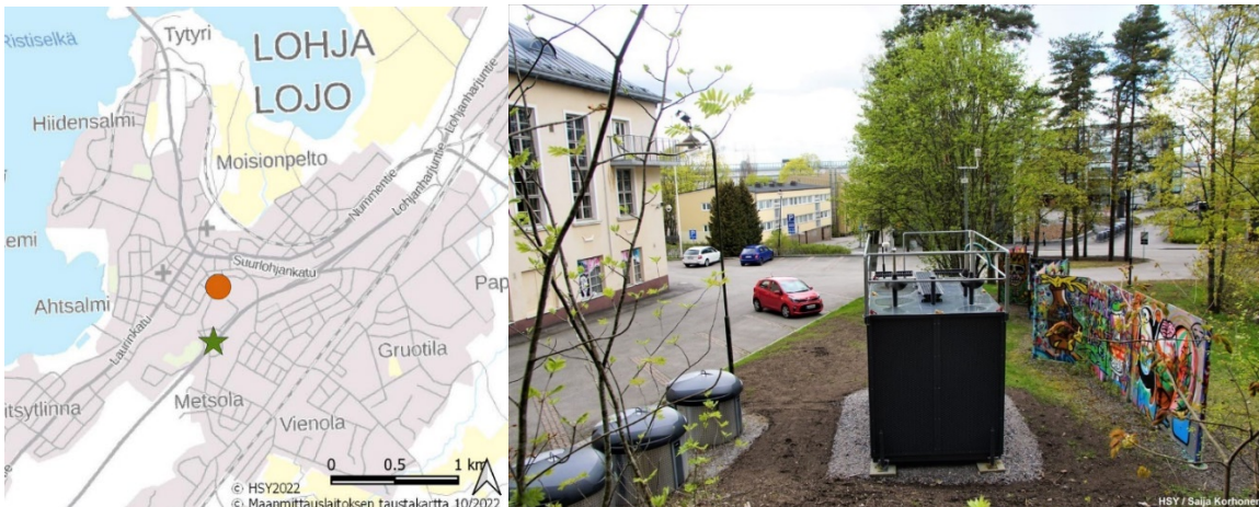
Kuva 9 a-b. Ilmanlaadun mittauspisteet Lohjalla vuonna 2022. a) kartta ja b) valokuva. Jatkuvatoinen asema on merkitty oranssilla ympyrällä ja typpidioksidin passiivikeräin vihreällä tähdellä. Bild 9 a-b. Mätpunkterna för luftkvalitet i Lojo år 2022. a) karta och b) fotografi. Mätstationen i kontinuerlig drift är markerad med en orange cirkel och passivinsamlaren för kvävedioxid med en grön stjärna.
