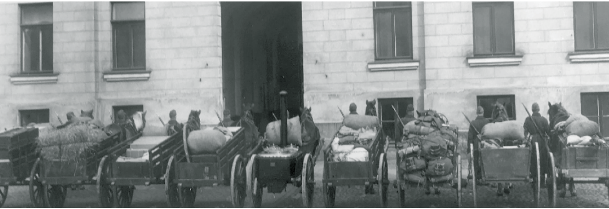
KUVA 37 ■ Kiväärikomppanian toimitusjoukkueen yhdeksän hevosten vetämää ajoneuvoa (kärryä). Kuvassa oikealta ensin kaksi vahvempirakenteista patruuna-ajoneuvoa, selkäreppuajoneuvo, teltta-ajoneuvo, kenttäkeitin, keittiöajoneuvo, muona-ajoneuvo, rehuajoneuvo ja yleiskäyttöön tarkoitettu tavara-ajoneuvo. Ajoneuvot kuuluivat liikuttaessa pataljoonan taistelukuormastoon. Kuusi ensimmäistä ajoneuvoa kuuluivat taistelukuormaston I osaan ja kolme viimeistä II osaan. 139
