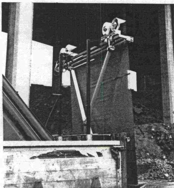
Baklämsfästet fastskruvas med två rattar. Höj- och sänkbart. Pilen kan enkelt ändras till vänsterpekande.
