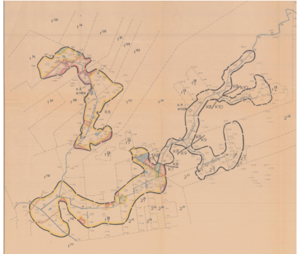
Kuva 6. Osa ojitusyhteisön ojitustoimituksessa vuonna 1972 vahvistetusta suunnitelmakartasta. Peruskuivatushankkeessa voi olla useita kuivatusalueita. Kuvassa kuivatusalueet K6–K10.
