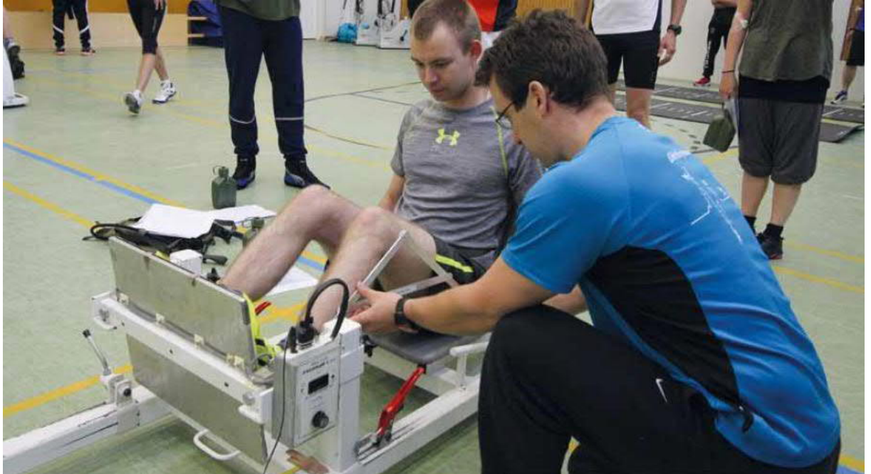
Kuva 4. Alaraajojen maksimivoiman mittaaminen dynamometrillä. (Kuva: Puolustusvoimat)
