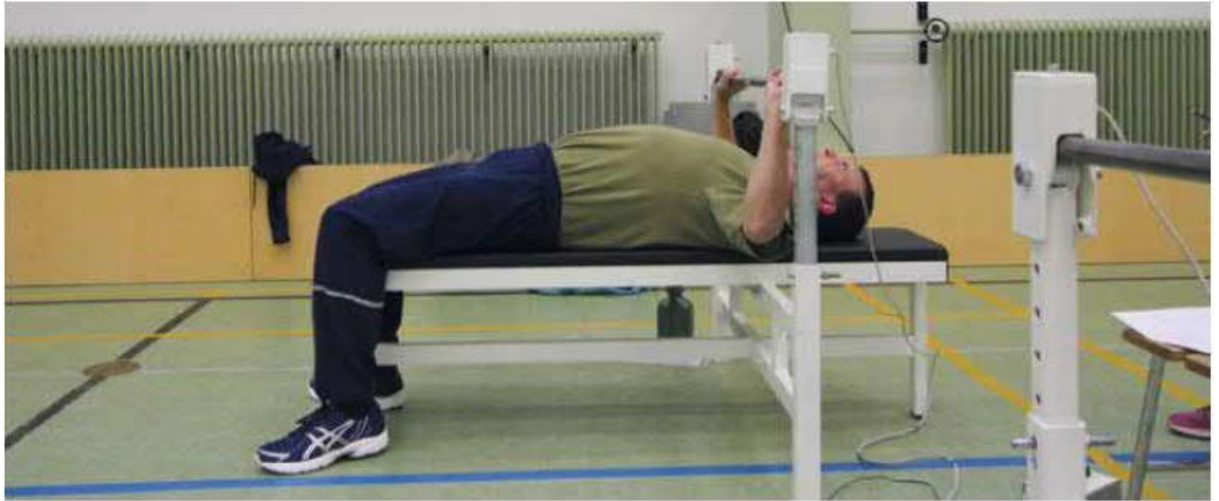
Kuva 5. Yläraajojen maksimivoiman mittaaminen dynamometrillä (Kuva: Puolustusvoimat)
