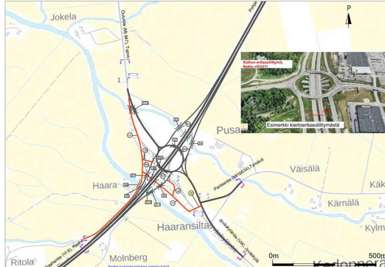
Kuva 19. Valtateiden 4 ja 8 eritasokiertoeritasoliittymä on esitetty voimassa olevassa Vt 8 ympäristön osayleiskaavassa. Ratkaisu ei täytä valtatie 4 nykyistä sujuvuus- ja nopeustasotavoitetta. (kuva: Valtateiden 4 ja 8 Haaransillan ETL-vaihtoehdot, 2018)
