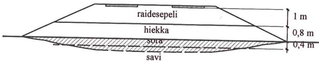
Kuva 66. Korja-Kouvola verifointikohteen skemaattinen pengerrakenne (Kolisoja et al. 2000).
