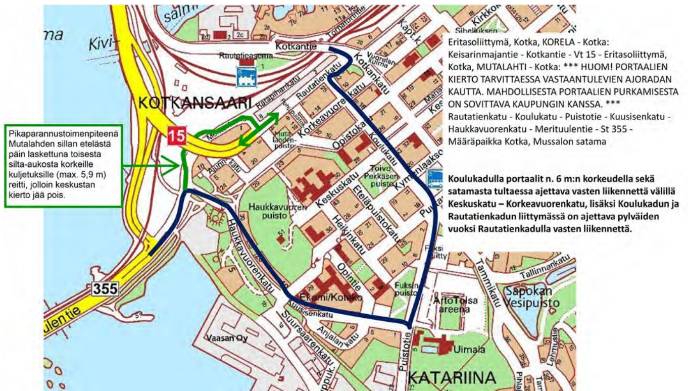
Kuva 82. Erikoiskuljetusten reitin pikaparannustoimenpide Haukavuoressa
