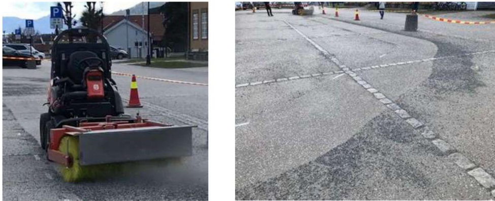
Kuva 4. Autonomisen harjakoneen demonstraatio (Karlsson et al 2020).
