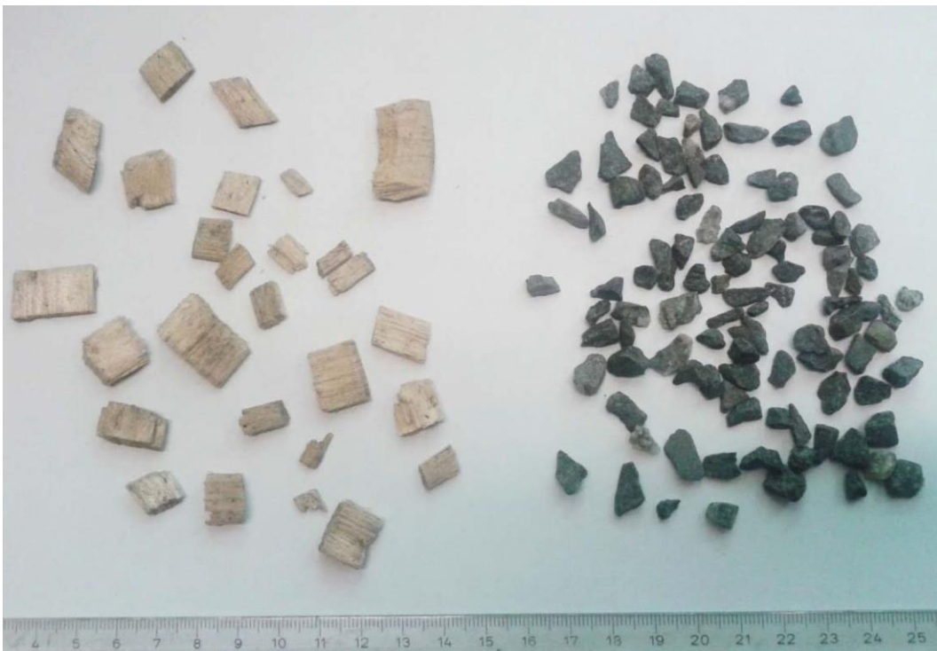
Kuva 3. Sveitsiläinen Stop Gliss Bio puulastuihin perustuva liukkaudentorjuntamateriaali verrattuna perinteiseen sepeliin.
