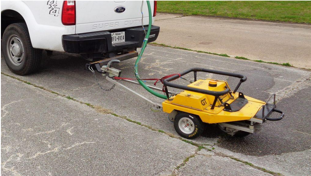
Kuva 15. Pienikokoinen mekaaninen GripTester kitkamittari ajoneuvoon kytkettynä (Transtec Group)
