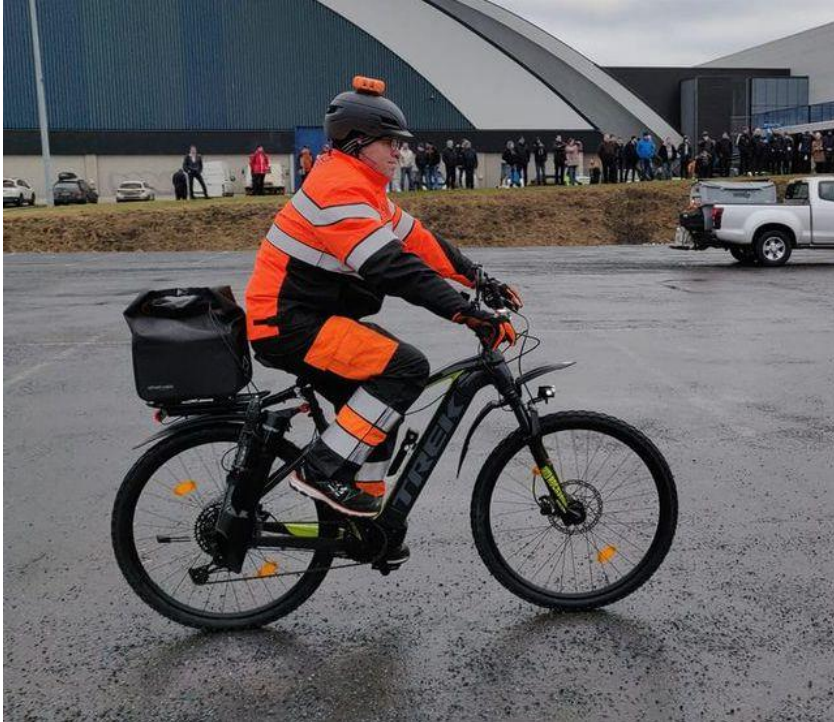
Kuva 17. Juha-Matti Vainion esittelemässä polkupyörään kiinnitettyä optista kitkamittausjärjestelmää (West Coast Road Masters 2020)
