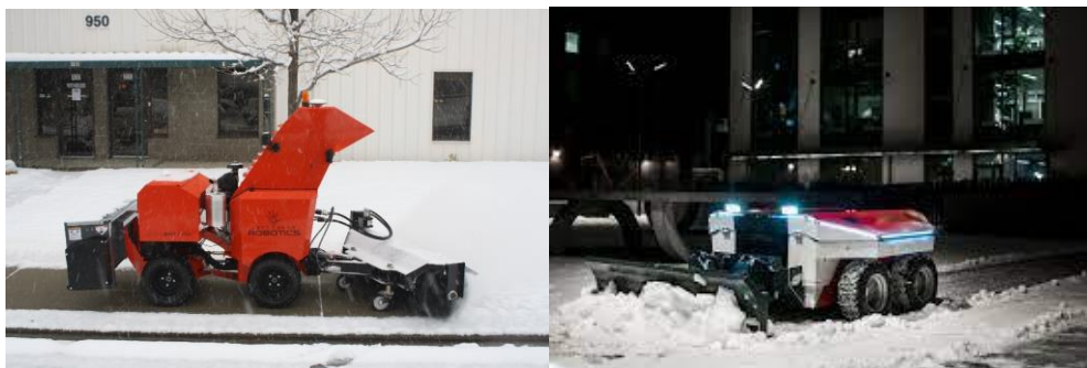
Kuva 5. Autonomista lumenpoistoa. Vasemmalla GPS-ohjattu amerikkalainen Power Broom, oikealla virolainen Lumebot. (Karlsson et al 2020).
