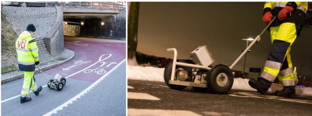
Kuva 11. VTI:n kehittämä Portable Friction Tester PFT.
