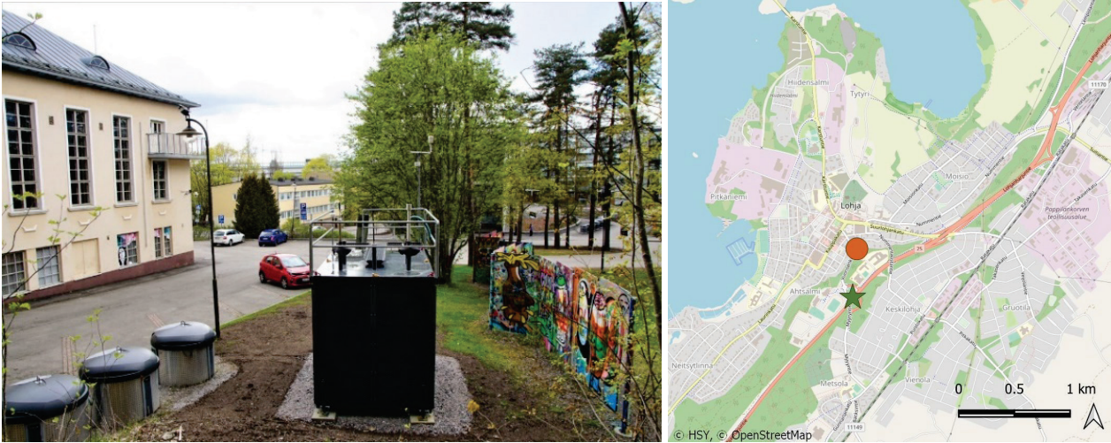
Kuva 9 a-b. Ilmanlaadun mittauspisteet Lohjalla vuonna 2020. a) kartta ja b) valokuva. Jatkuvatoinen asema on merkitty oranssilla ympyrällä ja typpidioksidin passiivikeräin vihreällä tähdellä. Bild 9 a-b. Mätpunkterna för luftkvalitet i Lojo år 2020. a) karta och b) fotografi. Mätstationen i kontinuerlig drift är markerad med en orange cirkel och passivinsamlaren för kvävedioxid med en grön stjärna.
