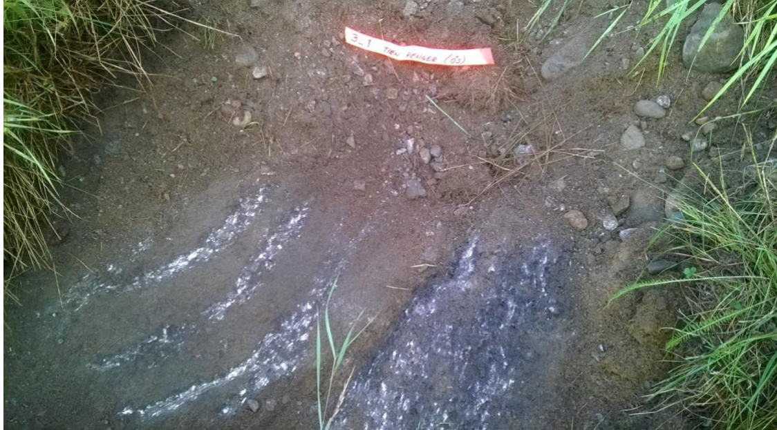
Kuva 2.3.3. Koekuoppa 3_1 (68/33/2261). Tiepenkereen vierestä kaivetussa koekuopassa oli 0,2 m syvyydellä asfalttia.
