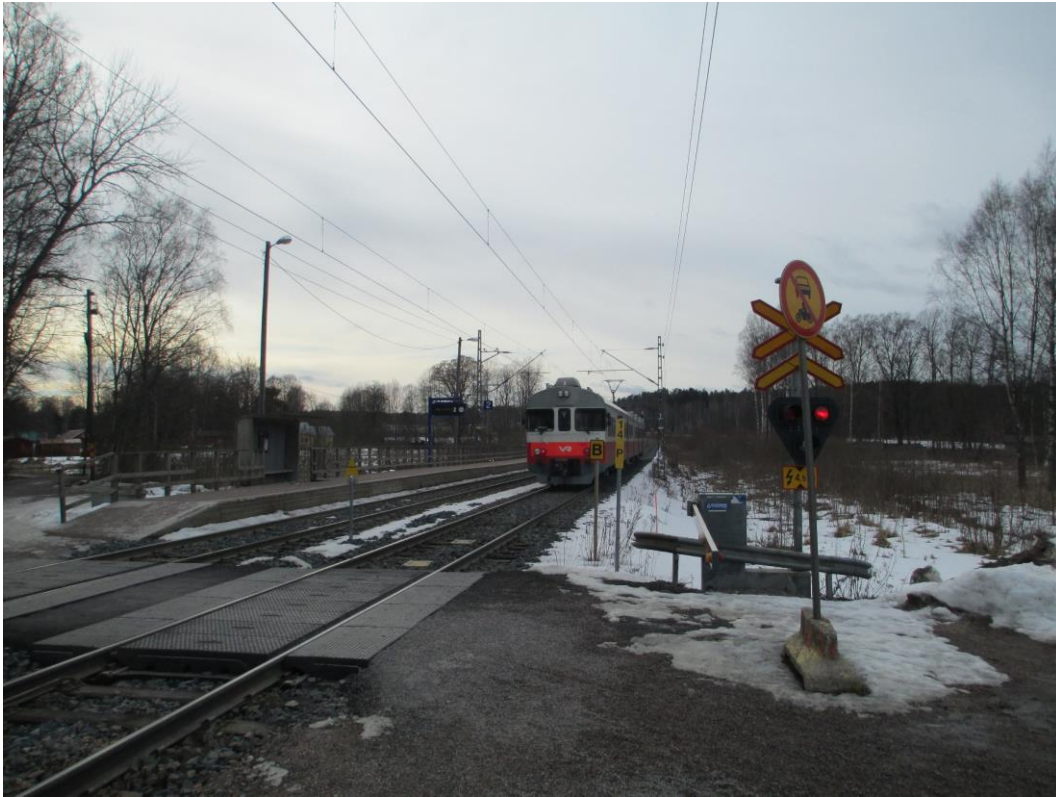
Kuva 8. Valmet valmisti Sm2-junia vuosina 1975–1981 yhteensä 50 kappaletta. Yksiköitä käytetään tällä hetkellä Etelä-Suomen taajamajunaliikenteessä sähköistetyillä rataosuuksilla. Ne eivät ole esteettömiä. Kuva: Jouni Kiviniitty. Espoo, 17.3.2016.
