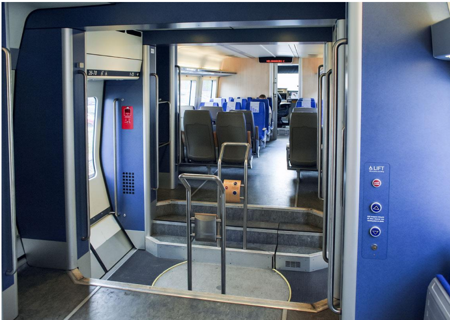
Kuva 21. Ruotsissa X50–X55 sarjojen sähkömoottorijunissa yksikössä yksi ovi on muita matalammalla korkeudella, joka tarjoaa esteettömän kulun junaan ja junasta. Junayksikköjen muu lattia on samassa tasossa, joten esteettömästä eteisestä yhteys junaan järjestetään nostolaitteella. Nostolaitteen pyöreä osa kääntyy 90 astetta ja nousee junan muun lattian tasolle, samoin osa viereisistä portaista nousee samaan tasoon nostinta käytettäessä. Nostolaitteen käyttö ei vaikuta pysähdysaikoja hidastavasti, sillä laitetta käyttävä henkilö voi jo junan liikkeessä laskeutua alatasolle odottamaan pysähdystä tai vastaavasti jo junan lähdettyä liikkeelle nostaa itsensä ylemmälle tasolle. Kuva: Järnväg.net /44/.
