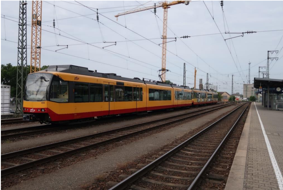
Kuva 4. Duoraitiovaunu kulkee kahdella eri sähköistysjärjestelmällä. Kuvassa oleva DUEWAGin, Siemensin, Adtranzin ja Bombardierin valmistama GT8-100D/25-M-sarjan duoraitiovaunu voi kulkea sekä raitiotieverkolla 750 V tasavirralla, että Saksan rataverkolla 15 kV 16,7 Hz:n vaihtovirralla. Kuva: Jouni Kiviniitty, Karlsruhe, 12.6.2018.
