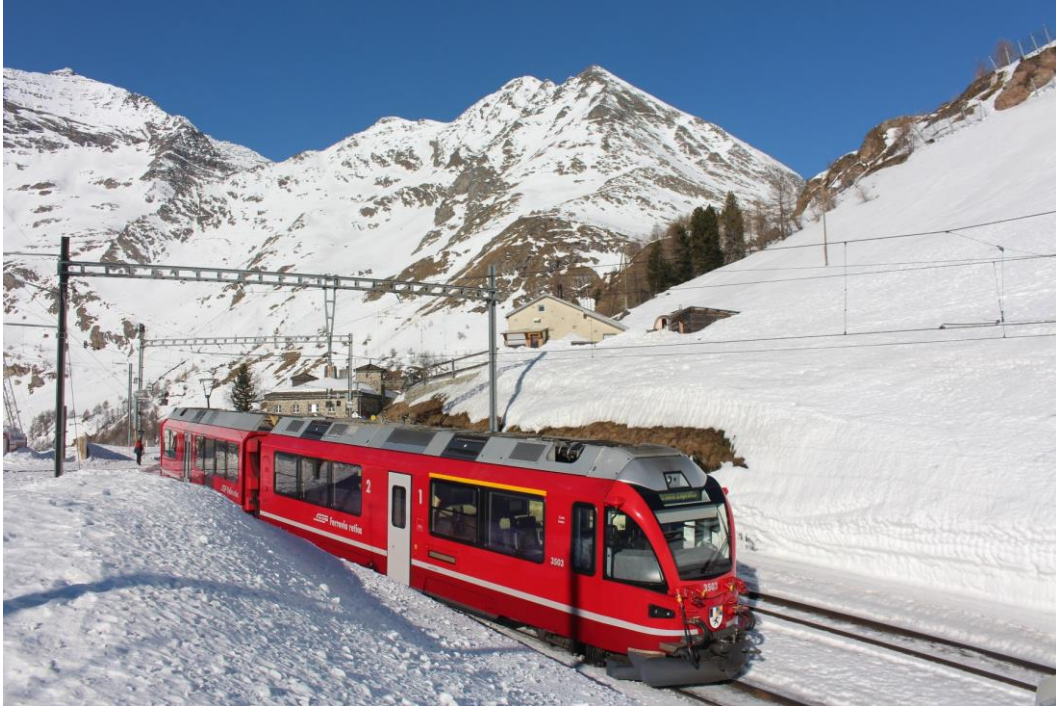
Kuva 9. Stadler Rail AG:n sveitsiläiselle Rhätische Bahnille valmistama kolmi-moduulinen paikallisliikenteeseen tarkoitettu moottorijuna. Stadler Rail AG toimitti tilaajalle näitä sveitsiläiseen luokkaan luokiteltuja RhB ABe 8/12-tyypin junia yhteensä 15 kappaletta vuosina 2009–2010. Yksiköissä on yhteensä 114 istumapaikkaa ja niiden huippunopeus on 100 km/h. Raideleveys on kapea 1000 mm. Kuva: Markku Nummelin. Alp Grüm, 17.1.2020.
