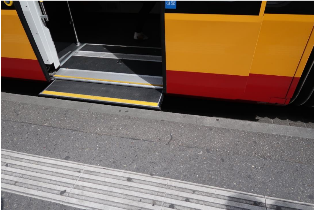
Kuva 19. Kalustoyksikön ja pysäkkikorokkeen välinen rako voidaan peittää vaunun alta työntyvällä lipalla. Kuva: Jouni Kiviniitty, Karlsruhe, 11.6.2018.
