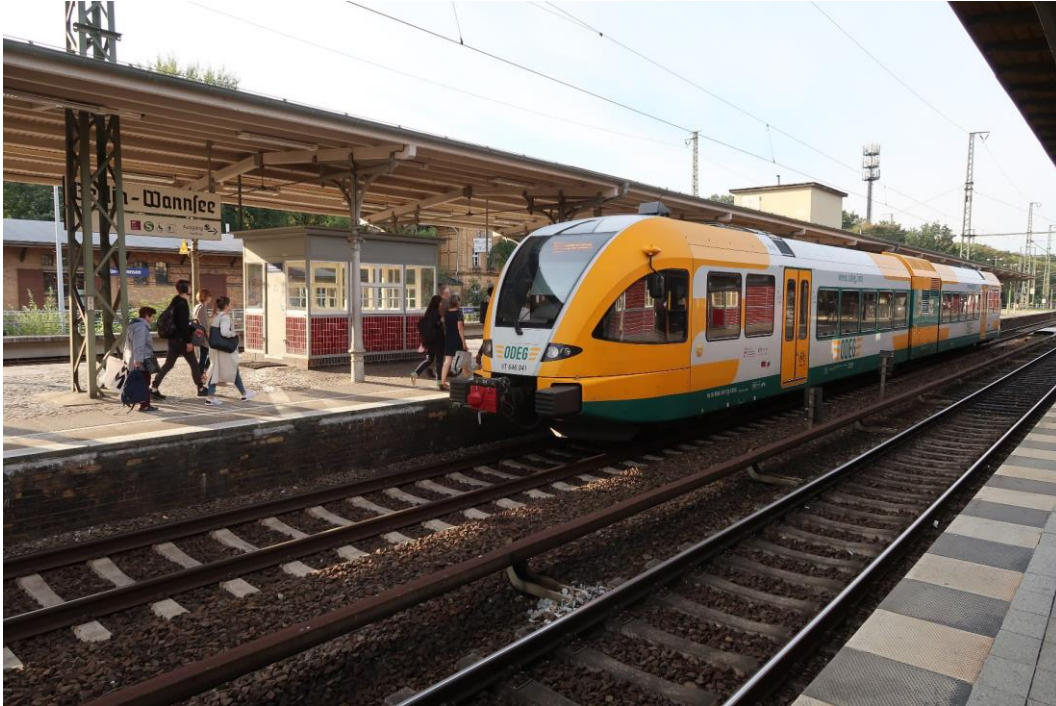
Kuva 2. Stadler Rail AG:n valmistama kolmimoduulinen, 40 m pitkä dieselmoottorivaunu Berliinissä. Yksiköstä on saatavilla myös sähkömoottorilla kulkeva versio. Kuva: Jouni Kiviniitty. Berliini, 20.9.2018.
