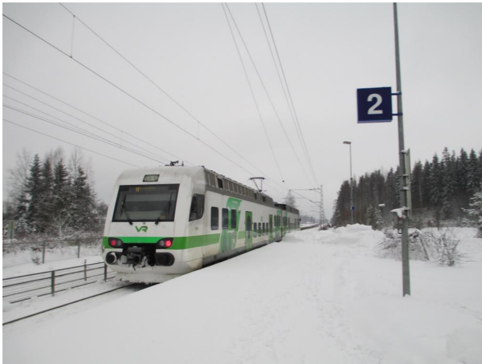
Kuva 7. CAFi:n, Fiat Ferroviarian ja Alstomin valmistamia Sm4-junia valmistettiin vuosina 1998–1999 sekä 2004–2005 yhteensä 30 kappaletta. Yksiköitä käytetään tällä hetkellä Etelä-Suomen taajamajunaliikenteessä sähköistetyillä rataosuksilla, erityisesti Helsingin ja Tampereen sekä Helsingin ja Lahden välisessä liikenteessä. Kuva: Jouni Kiviniitty. Tuusula, 21.2.2016.
