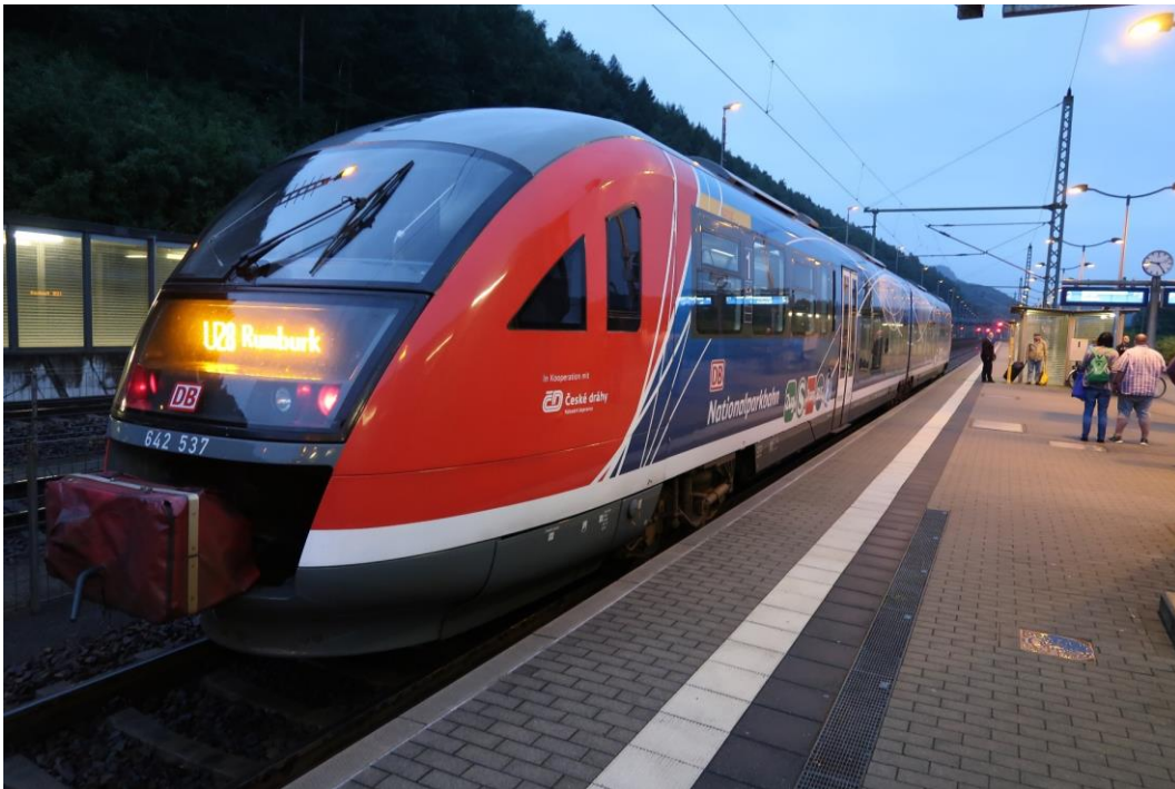
Kuva 11. Siemens Desiro-tyypin dieselmoottorivaunu. Kalustoa käytetään sähköistämättömillä rataosilla alue- ja paikallisliikenteessä. Junia toimitettiin yhteensä 320 kpl useille eri operattoreille vuosina 1999–2010. Yksiköissä on yhteensä 110 istumapaikkaa ja saman verran seisomapaikkoja. Kokonaismatkustajakapasiteetti on 210 matkustajaa. Huippunopeus on 120 km/h. Kuva: Jouni Kiviniitty. Bad Schandau, 23.6.2018.
