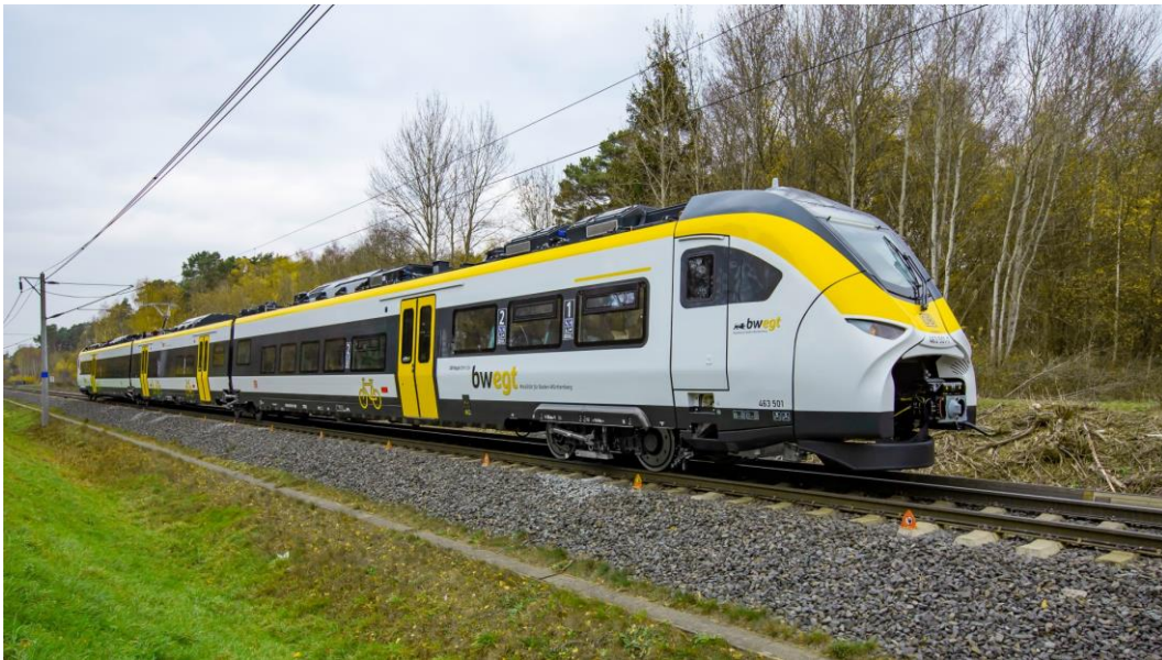
Kuva 13. Siemensin valmistama Mireo Plus B-moottorijunayksikkö on varustettu kattovirroittimen lisäksi akuilla ja se voi kulkea sähköistämättömillä rataosuuksilla. Valmistaja lupaa sarjavalvisteisten junien kulkevan yhdellä latauksella 100 km. Samasta junasta on saatavissa myös vetykäyttöinen versio. Kuva: Siemens.
