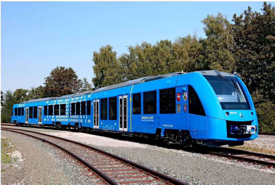
Kuva 12. Alstomin valmistama Coradia iLint-vetykäyttöinen juna esiteltiin vuonna 2016 Berliinin InnoTrans-messuilla. Junia on sittemmin käytetty Saksassa koeliikenteessä. Valmistajan ilmoituksen mukaan vetykäyttöisellä kalustolla voidaan ajaa yhdellä tankkauksella jopa 600–800 km. Matkustajanäkökulmasta juna ei eroa muista Alstomin Coradia-tuoteperheeseen kuuluvista junista. Kuva: Alstom.
