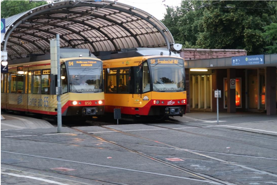
Kuva 10. Kaksi karlsruhelaista duoraitiovaunua. Vaunut kykenevät ajamaan sekä Saksan liittotasavallan rautatieverkolla 15 kV 16,7 Hz:n vaihtovirralla ja Karlsruhen raitioverkolla 750 V tasavirralla. DUEWAG:n, Siemensin, Adtranzin ja Bombardierin valmistamat GT8-100D/2S-M-tyypin vaunuja valmistettiin vuosina 1997–2005 yhteensä 86 kpl. Vaunuissa on 223 matkustajapaikkaa, joista sata istumapaikka. Huippunopeus on 100 km/h. Kuva: Jouni Kiviniitty. Karlsruhe, 11.6.2018.
