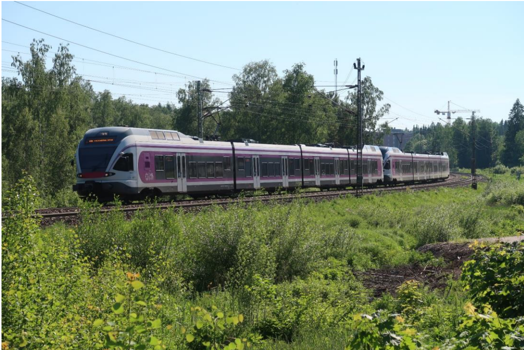
Kuva 6. Kaksi Junakalusto Oy:n omistamaa nelimoduulista Sm5-junayksikköä. Yksiköt perustuvat sveitsiläisen Stadler Rail AG:n valmistamaan Flirt-tuoteperheeseen, ja niitä on käytetty HSL-alueen sisäisessä kaupunkijunaliikenteessä vuodesta 2009. Yksiköitä on käytössä yhteensä 81 kappaletta. Kuva: Jouni Kiviniitty. Kauniainen, 11.6.2020.
