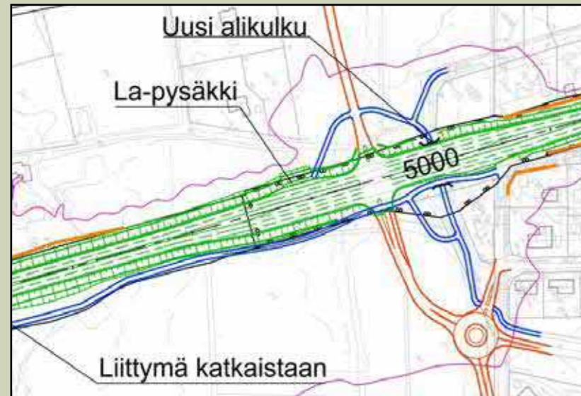
Kuva 17. Laivakankaantien liittymä siirtyy hieman Oulun suuntaan.
