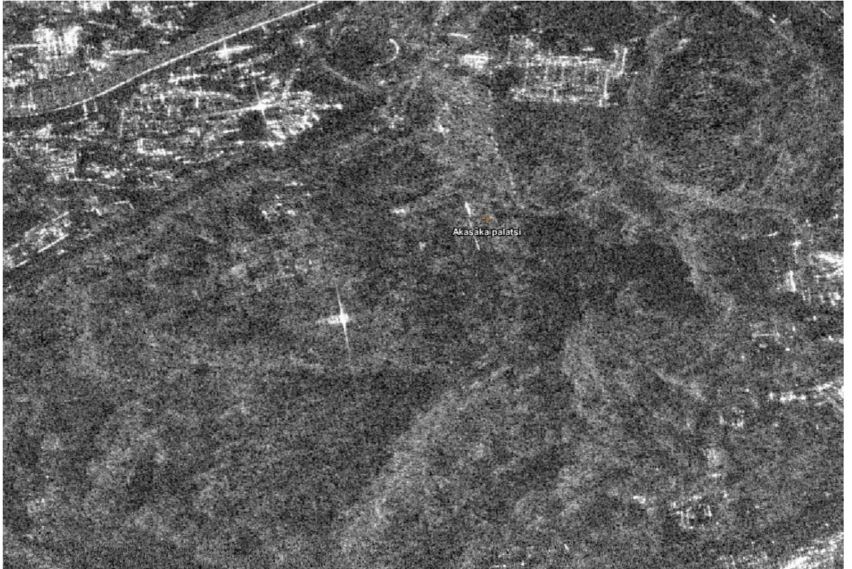
Akasakan palatsin alue. Rakennukset tunnistettavissa puiden lomasta. Kasvihuoneen lasikatto antaa todella kirkkaan palautteen kuvan keskellä. Ajoneuvoja vaikea erotella rakennuksista puiden takia. NIIRS-arvio 3.
