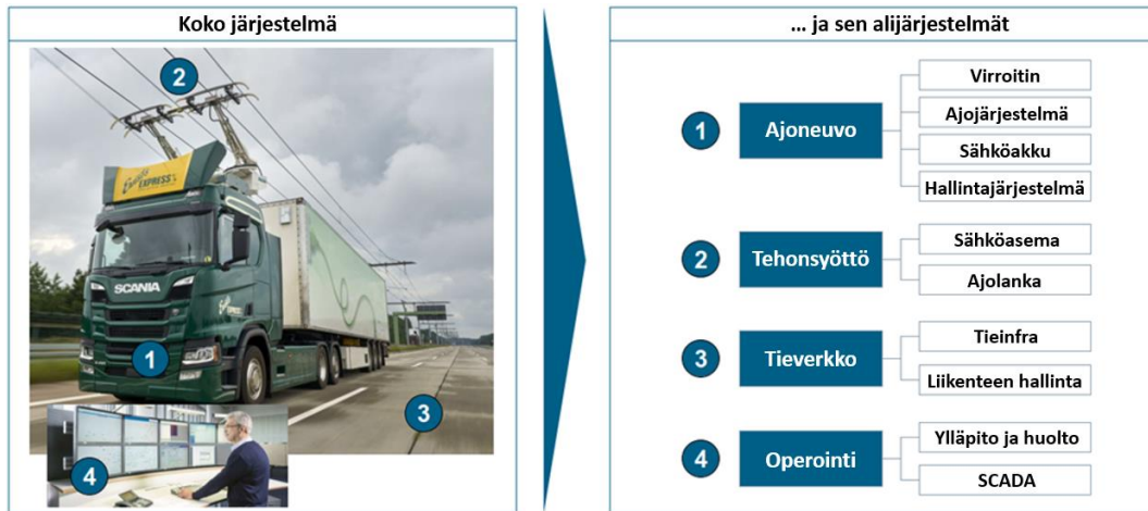
Kuva 4. Ajolankaan perustuva latausjärjestelmä ja sen osat. 4
