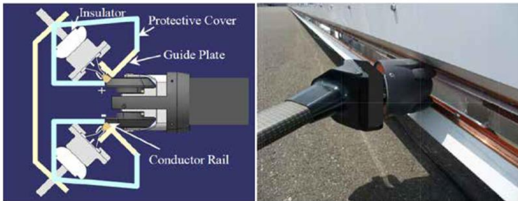
Kuva 7. Turvakaiteeseen integroitava latausraide ja sen detaljikuva.
