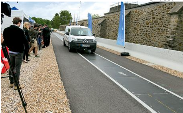
Qualcomm: Käämisilmukat tien sisällä (induktio)
