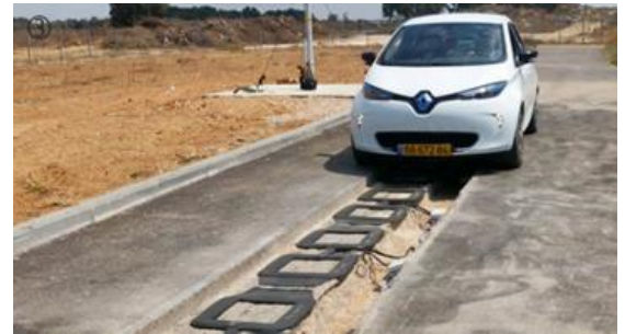
Kuva 8. Periaatekuva induktiolatauksesta ja liikkeessä tapahtuvan induktiolatauksen testiradasta 7,8
