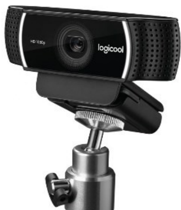
Figur 32 – Logitech C922 (till vänster) klarar av 60 fps för inspelning av naturlig rörelse, men endast vid HD resolution [61].
