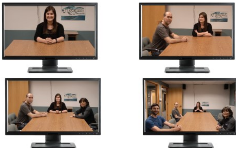
Figur 40 – Istället för dyra servon på X och Y led, brukas mjukvara för att finna människor i en video med vid vinkel.
