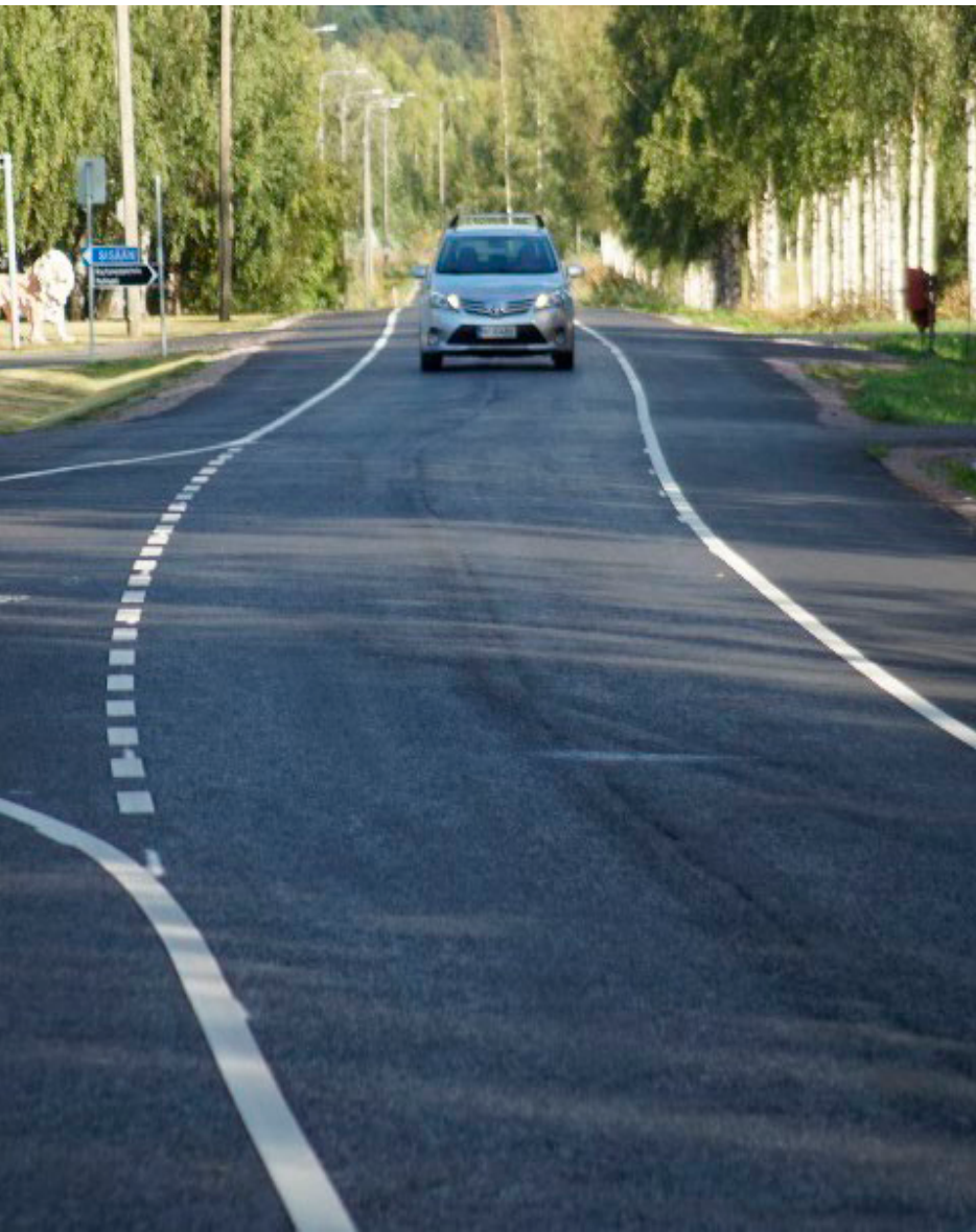
Kuva 23. Tiemerkitänä tavallinen yhtenäinen tien reunaviiva sekä linja-autopysäkin kohdalla reunaviivan jatke katkoviivana.
