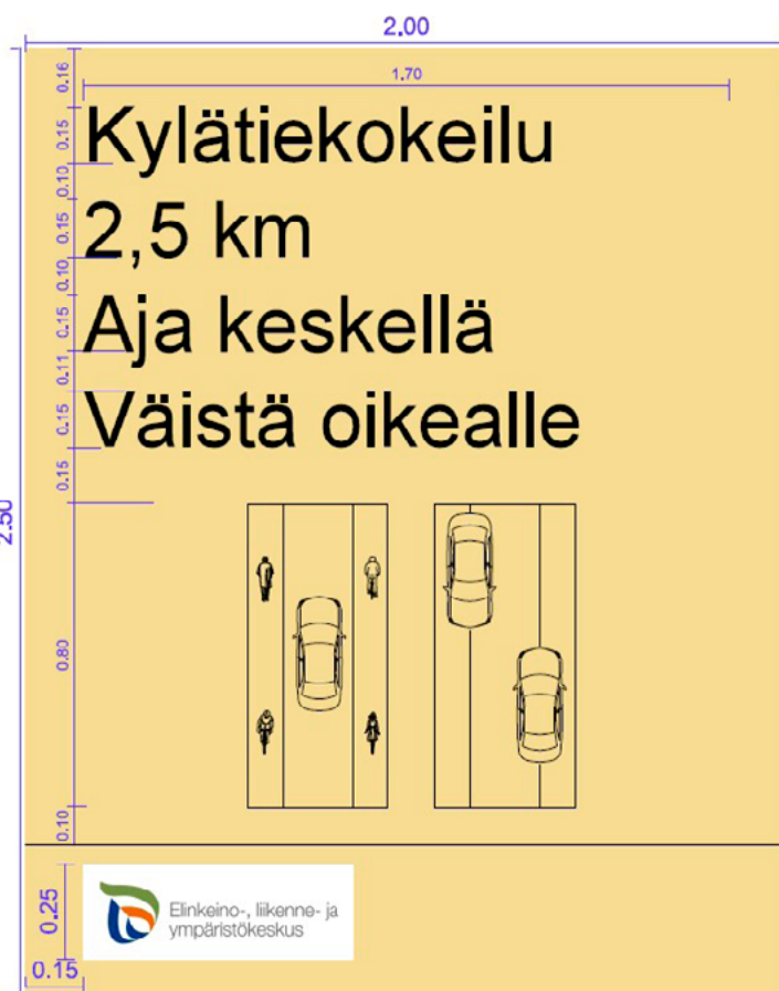
Kuva 28. Kylätielle sijoitetun opastaulun mitoituskuva
