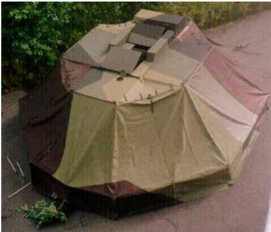
Kuva 63: Järjestelmien toimintakyky uhkaympäristössä edellyttää häivetekniikan huomioimista myös tukeutumisjärjestelyissä. Kuvassa kenttäkeitin M96 maastoutettuna järjestelmään kuuluvalla naamioverkolla. [SA kuva]
