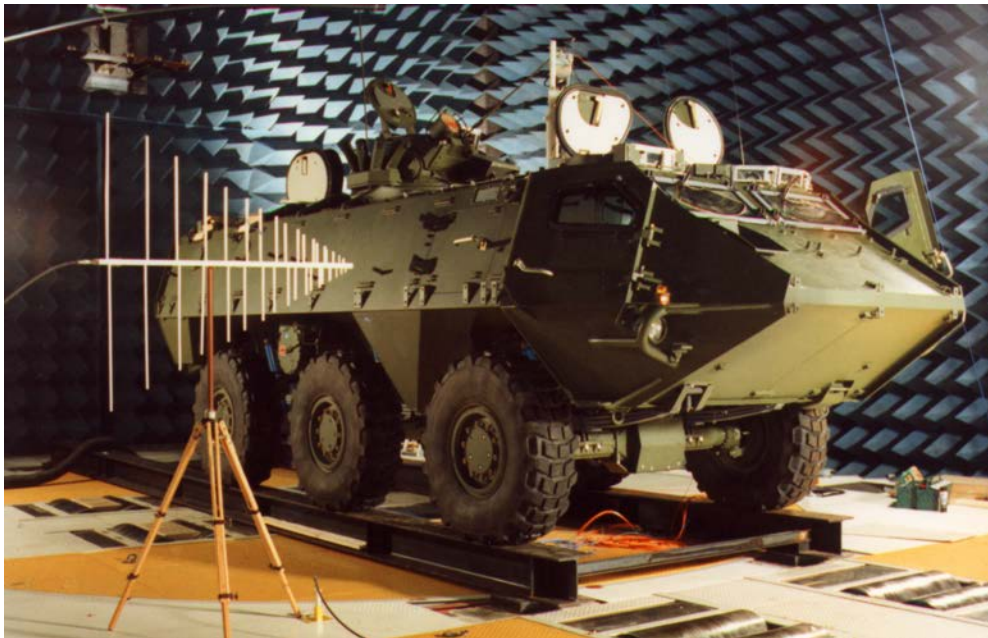
Kuva 68: Sähkömagneettisen yhteensopivuuden varmistaminen on välttämätön toimenpide järjestelmän toimintakyvyn takaamiseksi. Kuvassa panssariajoneuvo sähkömagneettisesti kaiuttomassa huoneessa. [Patria]
