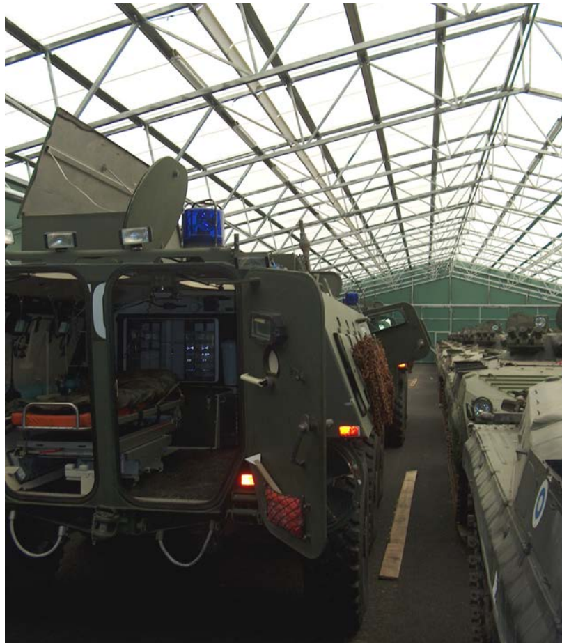
Kuva 116: Panssarivarikon kylmäkuivattua varastotilaa. Vasemmalla PASI:n ambulanssiversioita ja oikealla BMP-1 -rynnäkövaunuja. [SA kuva]
