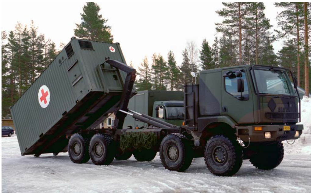
Kuva 74: Ajoneuvo-alustan, laitekontin ja siihen asennettavan järjestelmän muodostama kokonaiskorkeus yhden ehdottoman reunaehdon järjestelmän toteuttamiselle. Lääkintäkonttia ollaan nostamassa 8x8 maastokuorma-auton kyytiin. [SA kuva]
