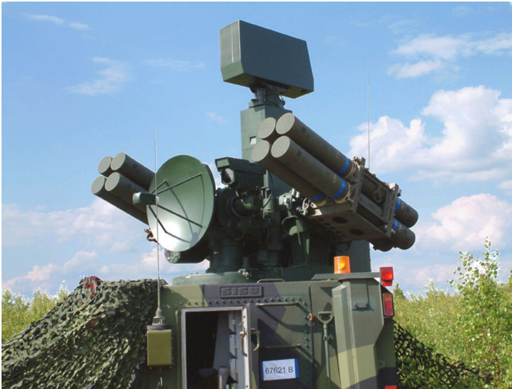
Kuva 107: Tehtäväprofiilin avulla laadittava käyttöprofiilin avulla voidaan saavuttaa merkittäviäkin elinjakso kustannussäästöjä. Se mahdollistaa sekä laitteiden oikean mitoituksen, että käyttötuntien minimoimisen. Esimerkiksi Crotale-ohjusjärjestelmässä lämpökamera on päällä aina kun järjestelmää käytetään riippumatta siitä tarvitaanko sitä vai ei. Tämän vuoksi lämpökameralle kertyy tarpeettomia kalliita käyttötunteja. Järjestelmän modifioinnissa tämä tunnistettu ongelma poistetaan. [SA kuva]
