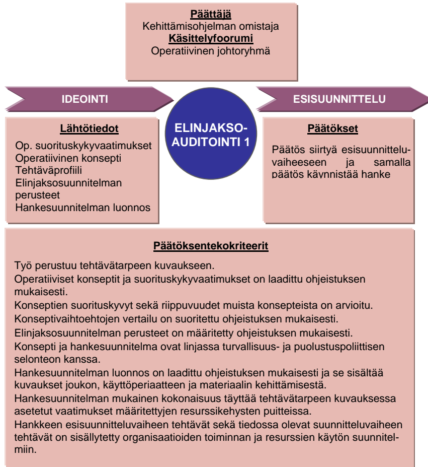
Kuva 49: Elinjaksoauditointi 1:n jälkeen kehittämissohjelman omistaja päättää käynnistetäänkö esisuunnitteluvaihe sekä käskee sen toteuttamisperusteet.
