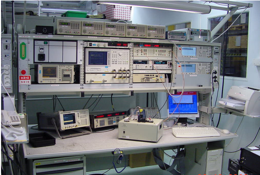
Kuva 111: Digitaaliset kenttäradiot sisältävät käytännössä tiedustelua välttelevän ja häirintää väistävän radion lisäksi tietokoneen ja tietoverkkopäätteen. Niiden huolto ja korjaus vaatii sekä erikoistyövälineitä että erityisammattilaisia. Kuvassa LV 241-, LV341- ja LV 342-radioiden C-tason huoltopisteen mittaus- ja testausvälineistöä. [T. Rintanen]
