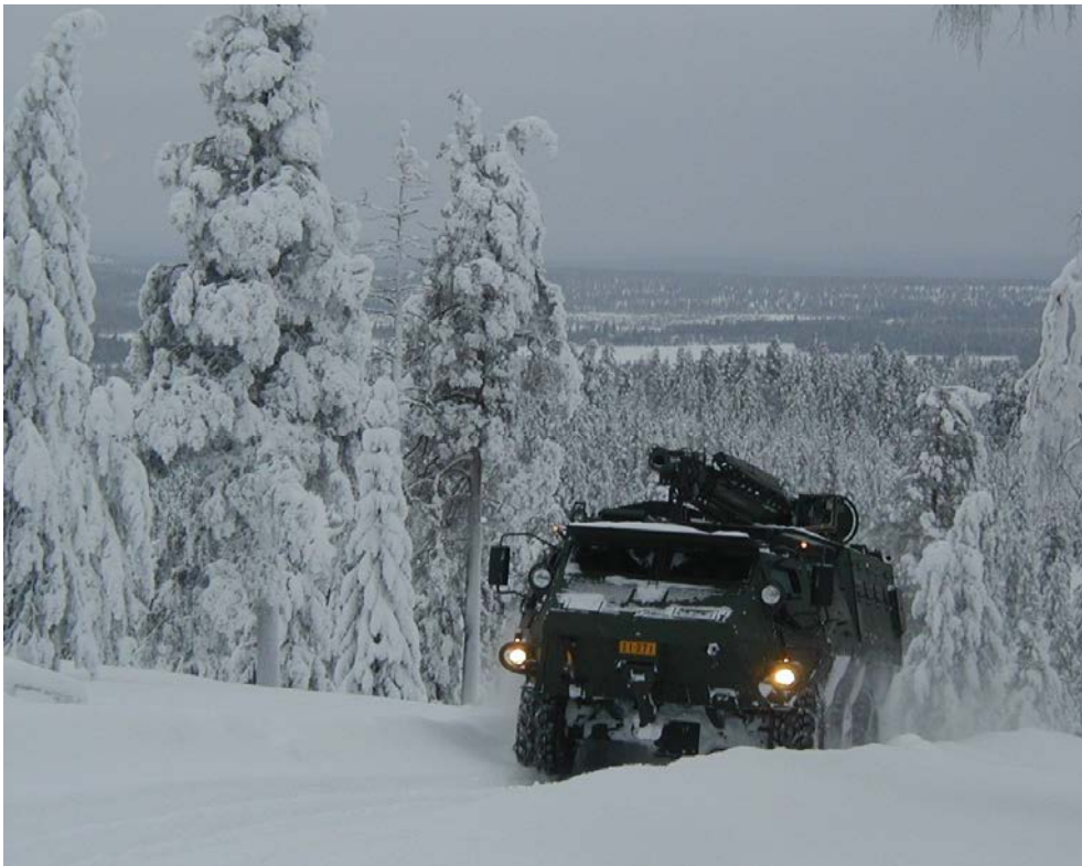
Kuva 124: Kenttäkokeilla voidaan täydentää, mutta ei korvata järjestelmän testausta selvittämällä järjestelmän toimivuutta ja käytettävyyttä todellisissa operatiivisissa olosuhteissa. Kuvassa XA-202-järjestelmäajoneuvo talvikokeilussa. [Patria]
