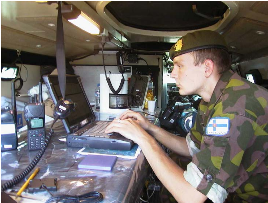
Kuva 151: Sotilaallisissa järjestelmissä käytetään koko ajan enemmän kaupallista teknologiaa (COTS), jonka elinjakso on yleensä huomattavasti lyhyempi kuin sotilas-tekniikan. COTS-tuotteita, kuten kuvassa näkyviä TETRA-puhelimia ja laptop-tietokoneita, sisältävän järjestelmän konfiguraatio muuttuu sen vuoksi taajaan, minä vuoksi sotavarustehyväksynnän hakeminen jokaisen muutoksen jälkeen ei ole perusteltua. [SA Kuva]
