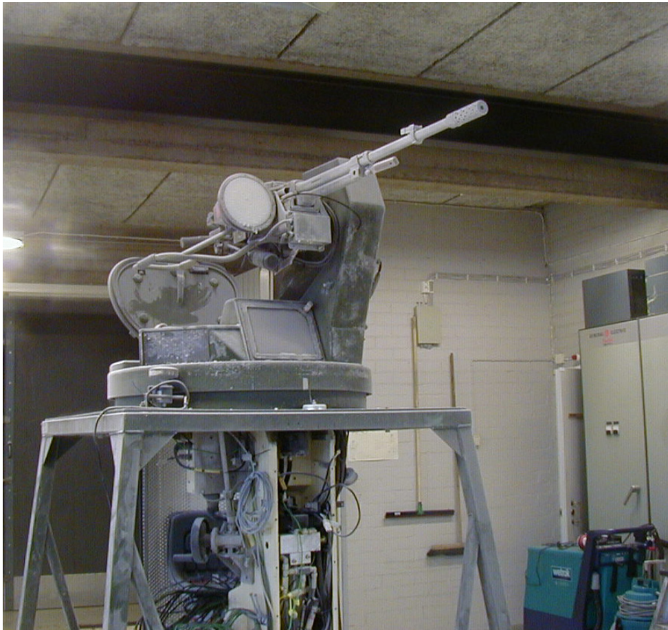
Kuva 105: AMV:n asejärjestelmä -40°C kylmätestauksessa. [Patria]
