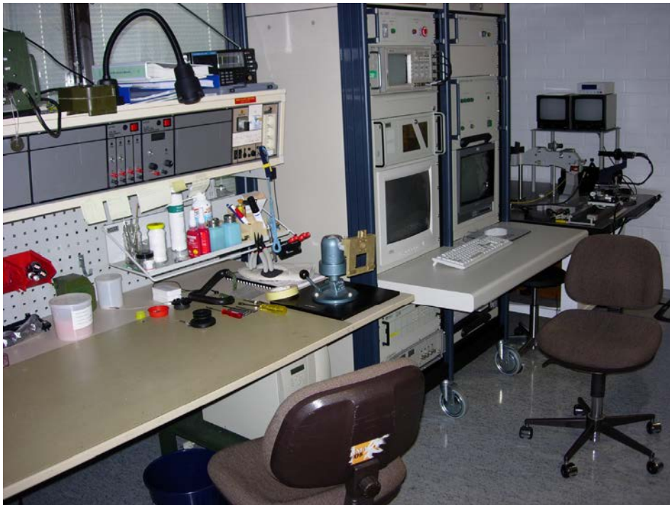
Kuva 112: Kunnossapitojärjestelyiden suunnittelun yhteydessä laaditaan myös työkalujen, mittauslaitteiden, testipenkkiä sekä työpisteiden hankinta- ja rakentamissuunnitelmat. Kuvassa ohjusjärjestelmän optroniikan korjauspiste. [J. Kosola]
