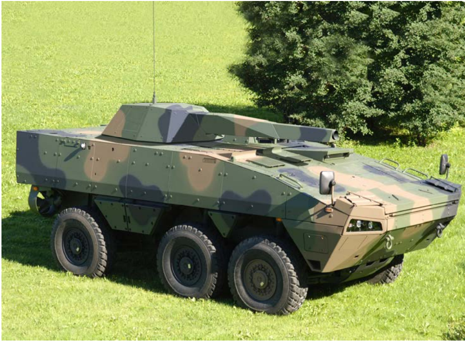
Kuva 119: Prototyyppi, jota ei todellisuudessa ole olemassa: virtuaaliprototyyppi Nemo-järjestelmästä 6x6 AMV:n alustalla. [Patria]
