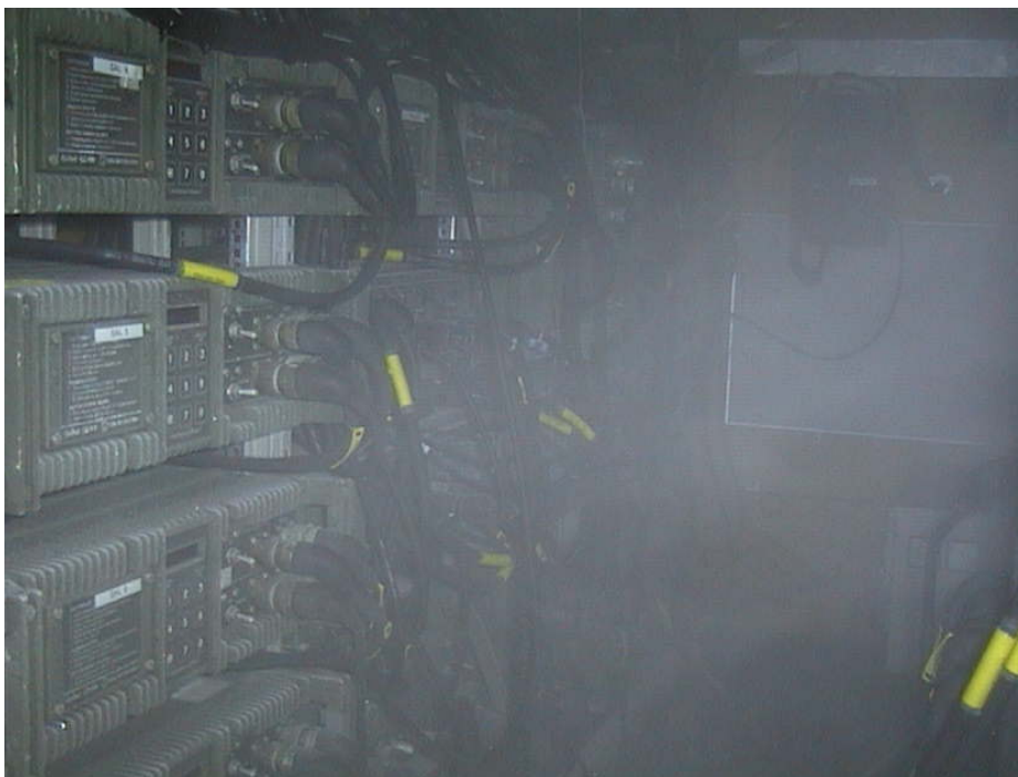
Kuva 145: Tyyppi hyväksynnän osana tehdään erilaisia ympäristöolosuhdetestejä. Kuvassa huurteinen YVI2-viestiasema -40 °C kylmätestissä. [J. Kosola]
