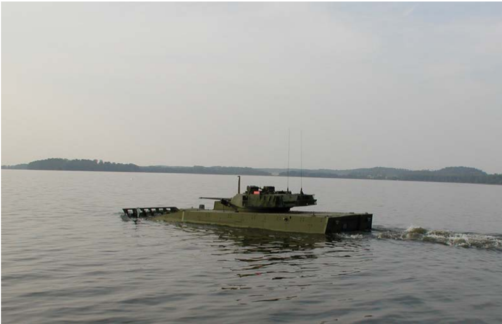
Kuva 39: Operatiivisesta konseptista tulee käydä ilmi suorituskyvyn käyttöajatus, esimerkiksi tuleeko joukon kyetä tekemään vesistökoukkauksia. Kuvassa Delcon asejärjestelmällä varustettu AMV ylittämässä vesistöä. [Patria]
