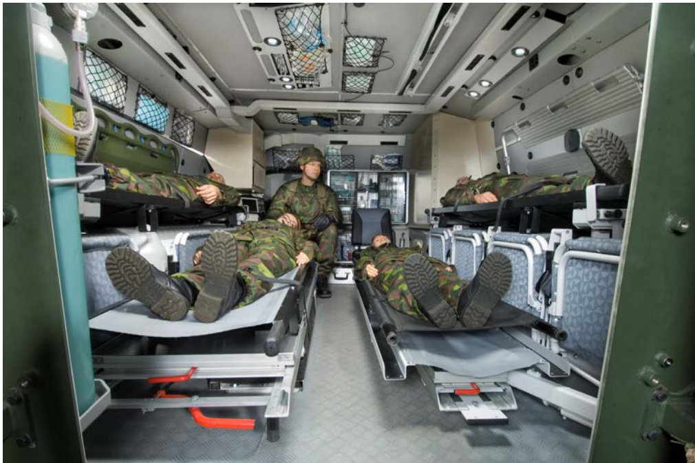
Kuva 127: Prototyyppien ja erilaisten toiminnallisten ja fyysisten mallien (mock-up) avulla voidaan kokeilla suunnitteluratkaisujen käytännön toimivuutta sekä jalostaa käyttäjän vaatimuksia. Kuvassa AMV:n ambulanssiversion mock-up. [Patria]
