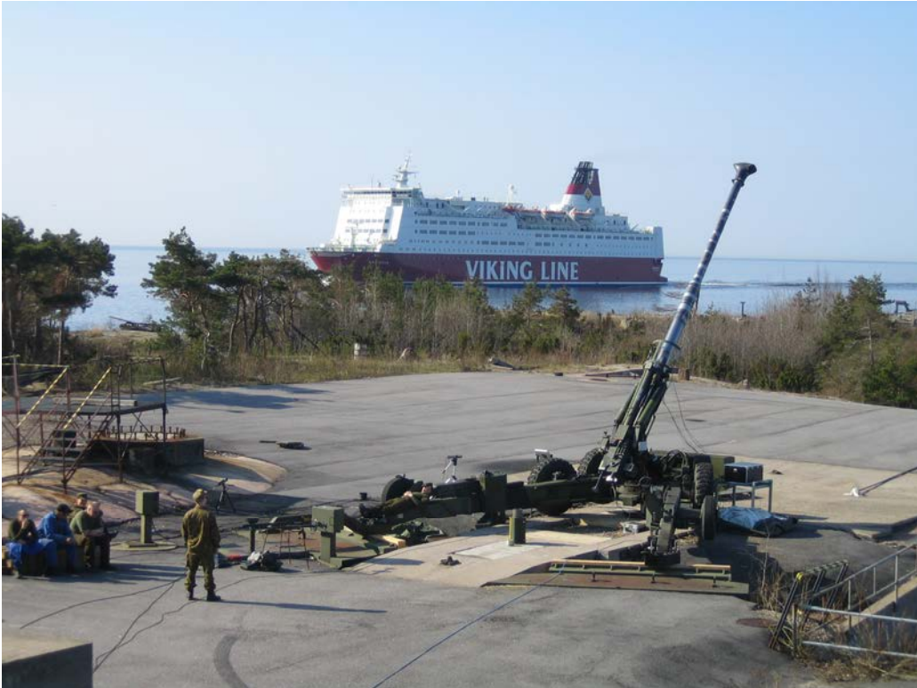
Kuva 147: Tyyppihyväksynnän osana tehdään myös rasiustestejä. Kuvassa 155 mm kenttätykin tuliputken ja koroakselin rasiusammunnat Koeampumalaitoksen Katajaluodon asemalla. [Patria Weapon Systems, Juha Mäki]
