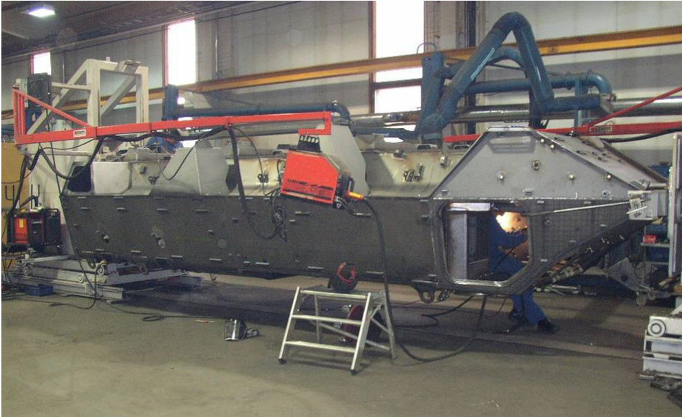
Kuva 144: Toimintajärjestelmän auditointiin kuuluu myös työvälineiden, henkilöstön ja noudatettavien menettelytapojen katselmointi. Kuvassa XA-203:n rungon hitsausta kääntölaitteessa. [Patria]
