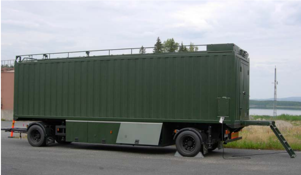
Kuva 114: Kriisiajan kunnossapito perustuu usein hajautettaviin ja siirrettäviin ratkaisuihin. Kuvassa elektroniikka- ja ohjusjärjestelmien korjaamoperävaunu. [J. Kosola]
