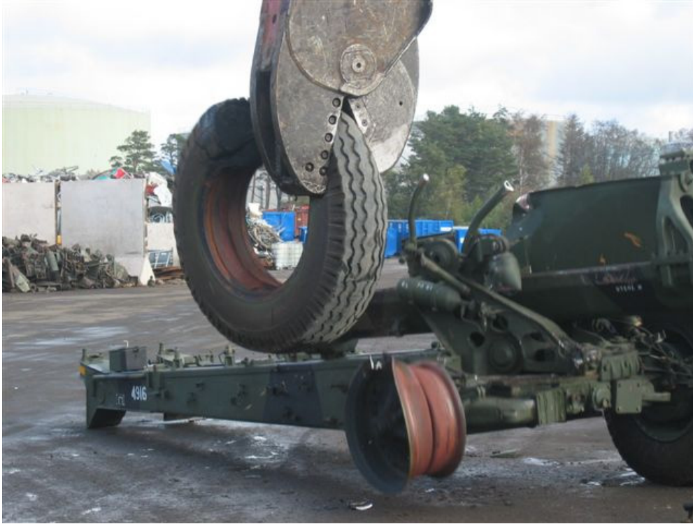
Kuva 125: Suunnitteluvaiheessa tulee tunnistaa purkamisvaiheen aikana todennäköiset erikoiskäsittelyä vaativat laitteet, osat ja materiaalit sekä määrittellä näiden hävittämisen edellyttämät erityisvaatimukset. 130K54-kenttätykin jälkikäsittelyä. [Stena Metall]
