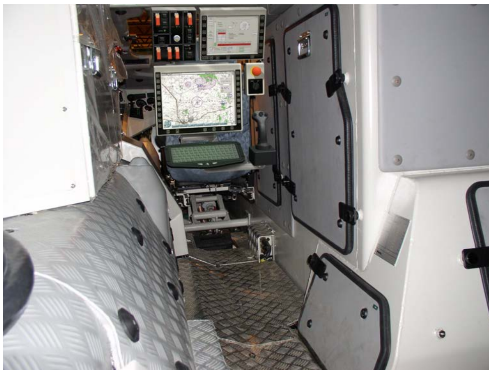
Kuva 62: Järjestelmän käyttöliittymän kehittämisessä ja vaatimusmäärittelyn tukemisessa on usein hyvä käyttää erilaisia toiminnallisia ja fyysisiä malleja. Kuvassa Nemo-kraanaatinheitinjoneuvon käyttöliittymän visualisointi AMV:ssä. [Patria]
