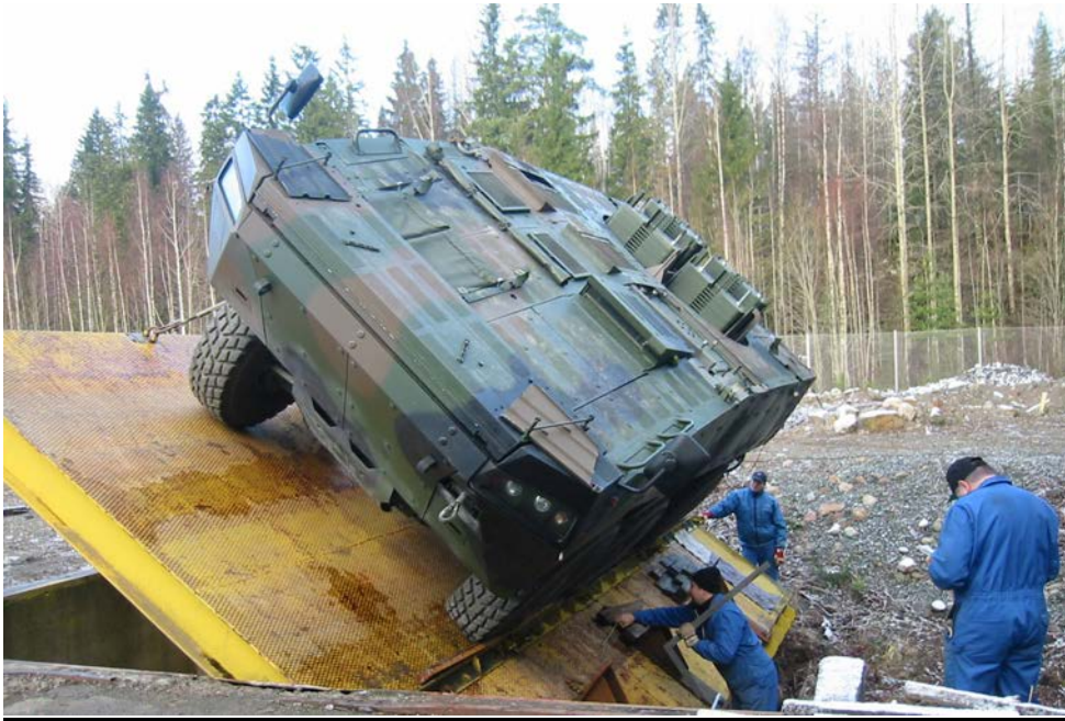
Kuva 143: Testaus suoritetaan suunnitellusti, toistettavasti ja dokumentoidusti. Testauksen perusteella tehdään evaluointi, jonka tulosten perusteella tehdään tyyppin hyväksyntä- tai hylkäyspäätös. Kuvassa AMV:n kallistustestaus osana tyyppitestausta. [Patria]
