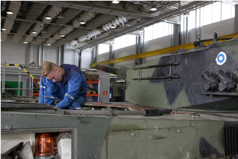
Kuva 150: Järjestelmien huollettavuus määräytyy suunnittelu- ja rakentamisvaiheen aikana tehdyistä päätöksistä. Hyvä huollettavuus vaikuttaa huomattavassa määrin järjestelmän käyttövarmuuteen ja sen kautta operatiiviseen käytettävyyteen. Kuvassa Leopard 2A4-panssarivaunun moottorin huoltoa Parolan korjaamolla. [SA kuva]
