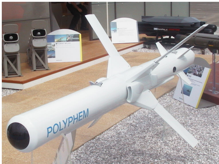
Kuva 44: Erilaiset konseptit voivat tuottaa hyvinkin erityyppistä suorituskykyä. Esimerkiksi valokuituohjattavia aseita voidaan käyttää maalien tuhoamisen lisäksi myös maalialueen tiedusteluun sekä hyökkäyksen jälkeen asevaikutuksella saavutetun tuloksen arviointiin. Kuvassa kuituohjattu Polyphem-ohjus. [J. Kosola]
