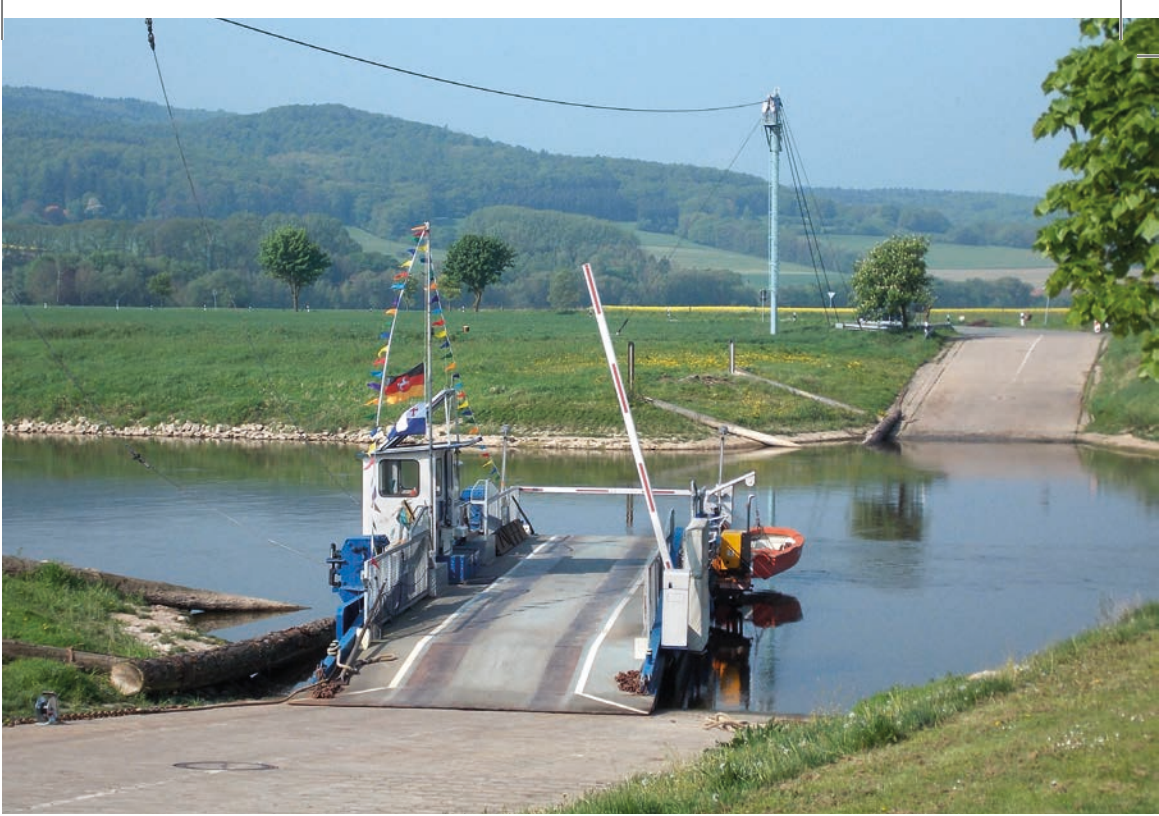
Weserin voi ylittää monessa paikassa Gierseilfährellä. Kun tällainen lossi käännetään sopivaan kulmaan, se saa liikkumiseen tarvittavan energian joen virtauksesta.
