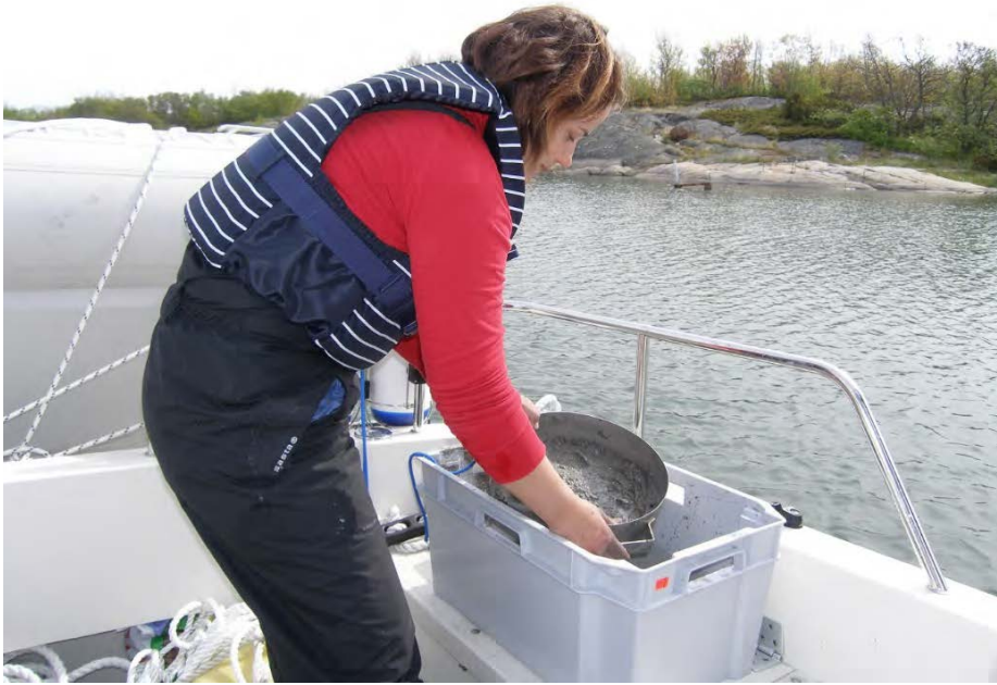
Kuva 4. Pohjaeläinnäytteen seulontaa veneessä. Pohjanäytteestä poistetaan seulomalla ensin pohjamateriaali ennen näytteen säilöntää. Kuva: © METSÄHALLITUS 2005
