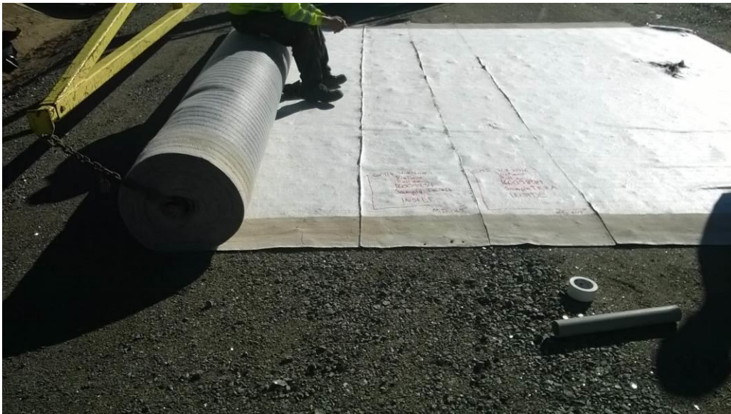
Kuva 5. Bentoniittimattonäytteiden leikkaaminen täydestä rullasta. Kuvassa näkyvät näytteeseen tehtävät merkinnät.
