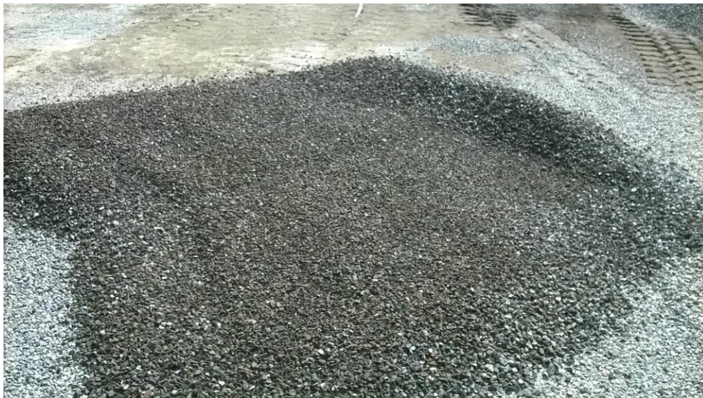
Kuva 1. Kauhakuormaajalla tasaiseksi matoksi levitettyä materiaalia, josta on otettu näytteitä satunnaisista paikoista.
