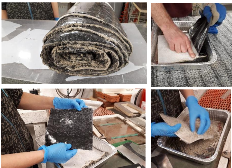
Kuva 46. Kuvia bentoniittimattönäytteiden käsittelystä. Yllynnä vasemmalla näyte ja oikealla kalvon irrotusta. Alhaalla vasemmalla testi-näytteestä irrotettu kalvo ja oikealla bentoniitin irrotusta vesipitoisuus- ja paisumisindeksimäärittystä varten.
