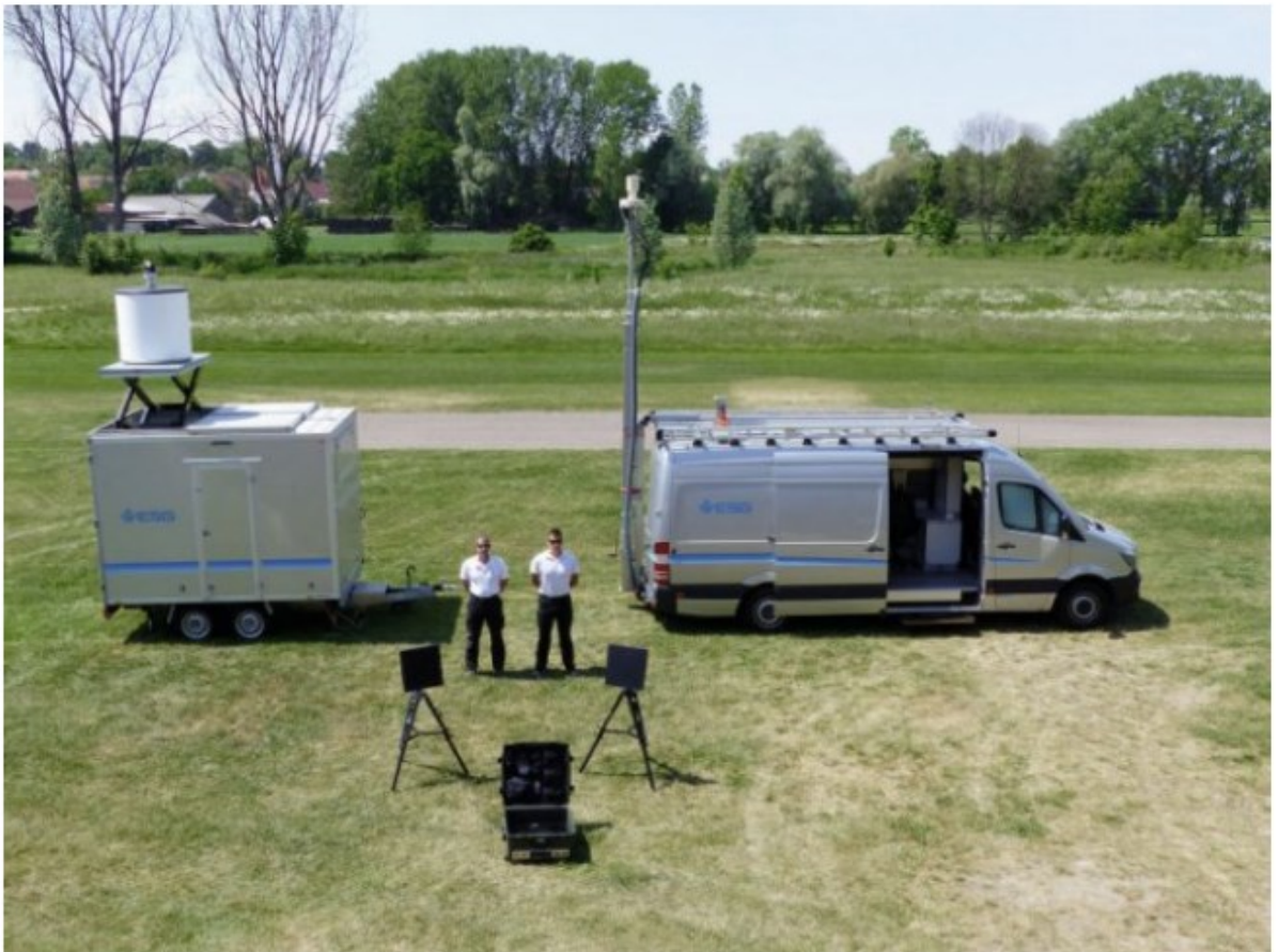
Kuva 9 Guardion-järjestelmä ilman ARDRONIS-asemia [69]
