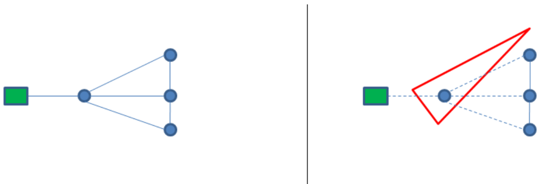
Kuva 16 Elektroninen vaikuttaminen mesh-verkon solmukohtaan
