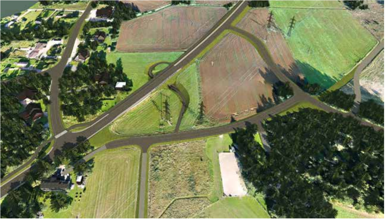
Kuva 24. Vaihtoehdon 1a vasen-oikeaporrastus, jossa Pertuntie katkaistaan ja porrastetaan pohjoisemmaksi uuteen liittymäkoh- taan. Nukarintien liittymä säilyy nykyisellään
