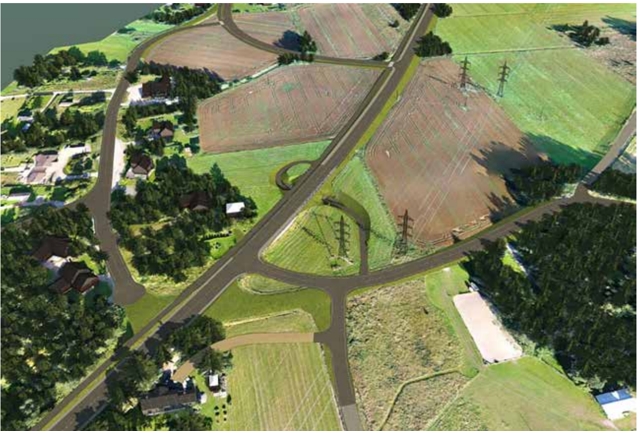
Kuva 25. Vaihtoehdon 1b oikea-vasenporrastus, jossa Nukarintie katkaistaan ja porrastetaan pohjoisemmaksi uuteen liittymäkoh- taan kantatielle. Pertuntien liittymäkulmaa oikaistaan
