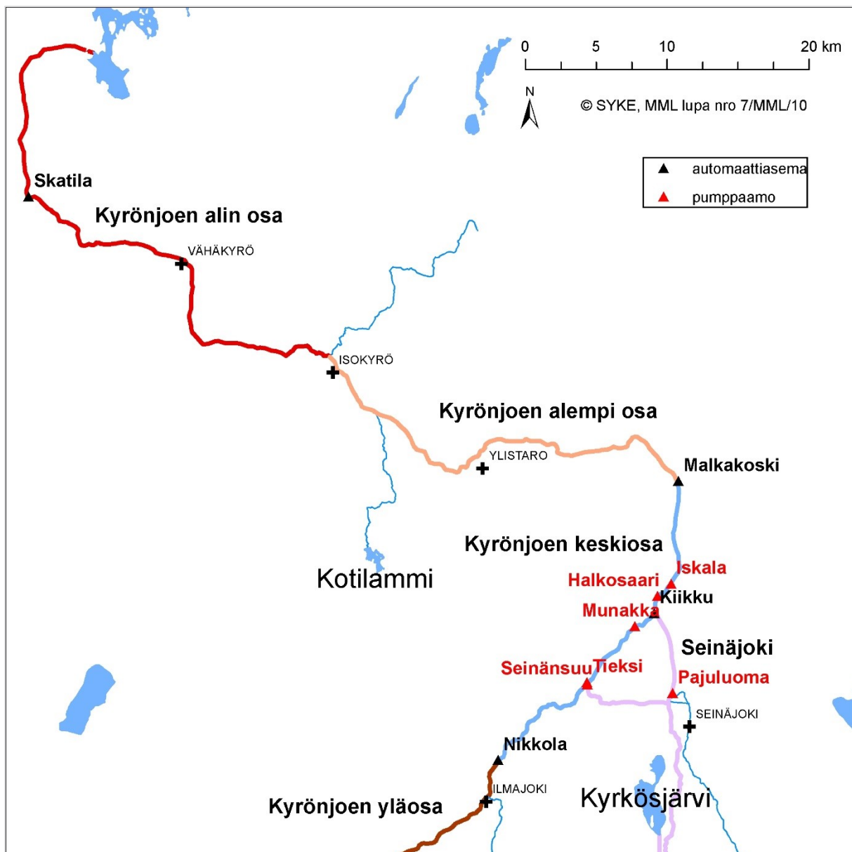
Kuva 5. Kyrönjoen tulvasuojeluhankkeeseen liittyvien pumppaamojen ja automaattiasemien sijainti sekä Kyrönjoen vesimuodostumat.
