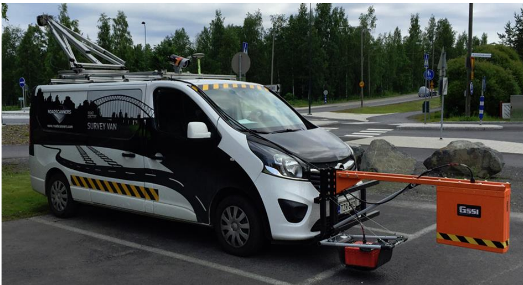
Kuva 7. Roadscanners RDSV. Edessä kaksi maatutka-antennia: horn-antenni ja maavasteantenni. Katolla kaksi kameraa ja takana ylhäällä laserskanneri, GPS ja IMU.
