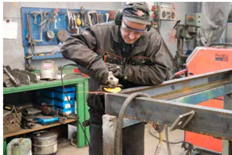
Matti Korhonen työskentelee uudessa hallissa kookkaita rakenteita ja osia muille yrityksille. Rälläkän käsittelyssä kuvassa Ekokympille tuleva katos.
