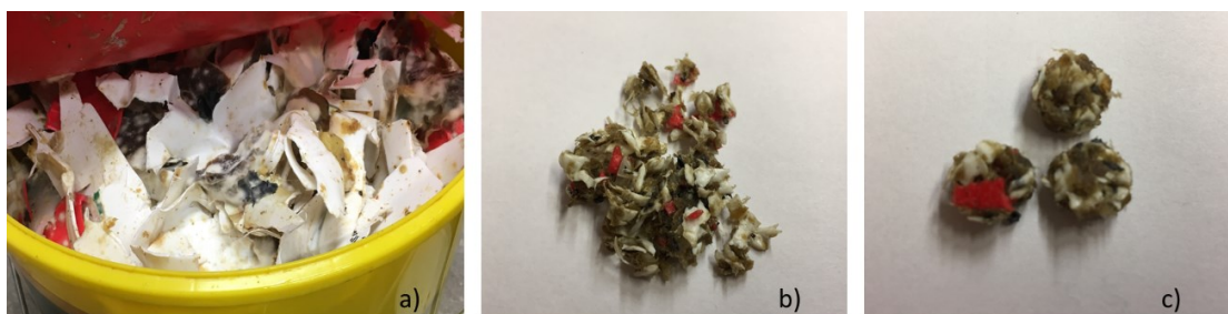
Figur 15. Obehandlat plastrejekt (a), homogeniserat plastrejekt (b) och pelleterat plastrejekt (c).
