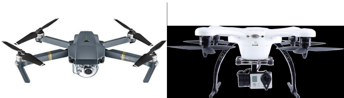
Kuva 3 & 4: DJI Mavic ja Ehang Ghost, ensimmäisessä roottorit asennettu osoittamaan ylöspäin ja toisessa alaspäin [68] [34]
