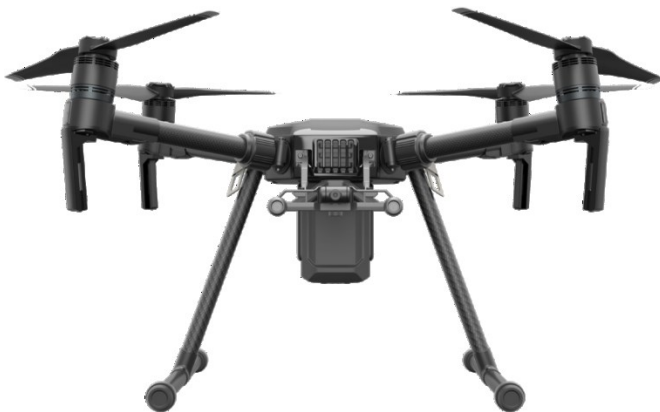
Kuva 6: DJI:n Matrice 200, jossa hiilikuituiset laskutelineet ja roottorien tukivarret [12]
