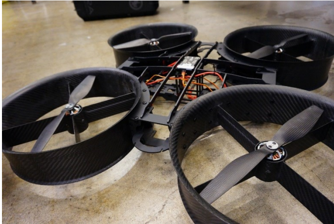
Kuva 5: Quadrokopterin runko roottorikanavilla varustettuna [85]
