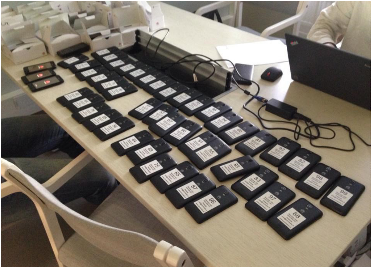
Kuva 4. Tuhannen puhelimen asennusurakkaa. Jokainen puhelin merkittiin tarralla, lisättiin tietokantaan ja asennettiin projektissa.
