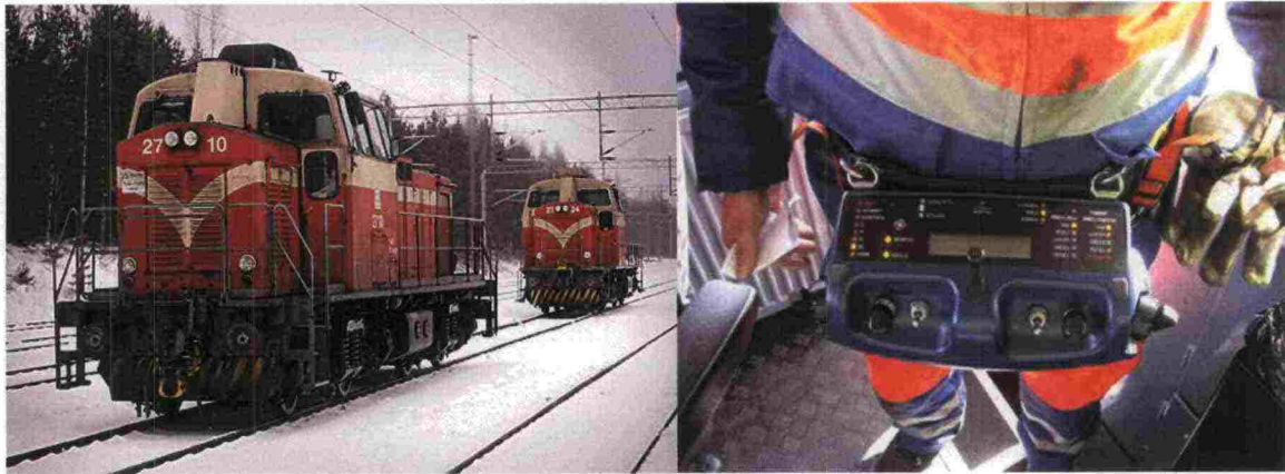
Kuva 20. Vasemmalla radio-ohjattuja Dv12-vetureita ratapihalla ja oikealla veturin hallintalaitte vaihtotyönjohtajalla käytössä Kuusankoskella.
