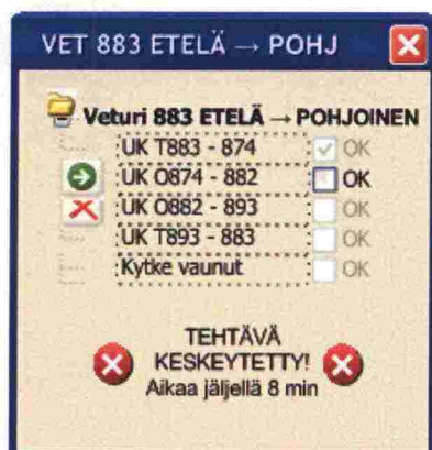
Kuva 16. Mobiililaitteen käyttöliittymässä tehtävä keskeytyy.
