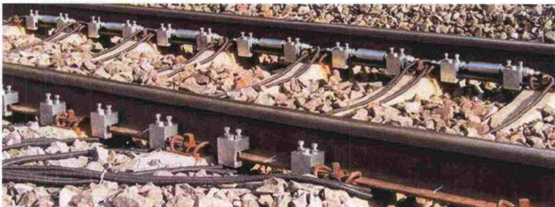
Kuva 19. Mattild/Lasca-aseman anturit kiskoon kiinnitettyinä
