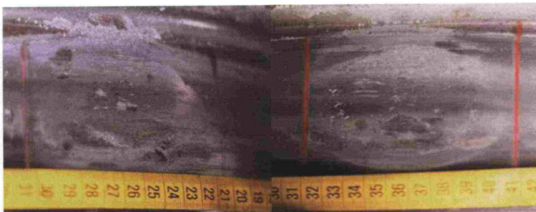
Kuva 59. Vaunun 8 akseleilta 2 ja 3 löytyneet viat
