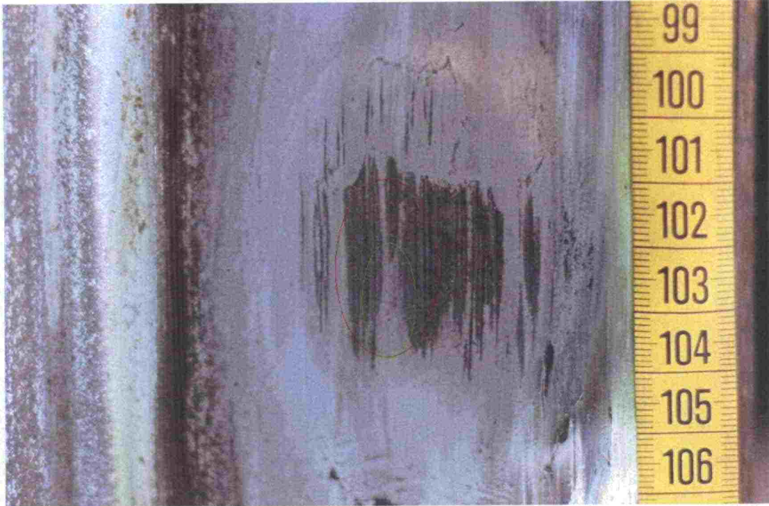
Kuva 57. Pyörän ja kiskon välinen kosketuspinta-ala. Punaisella on merkitty täyden kuorman tapaus ja vihreällä tyhjään vaunun tapaus.
