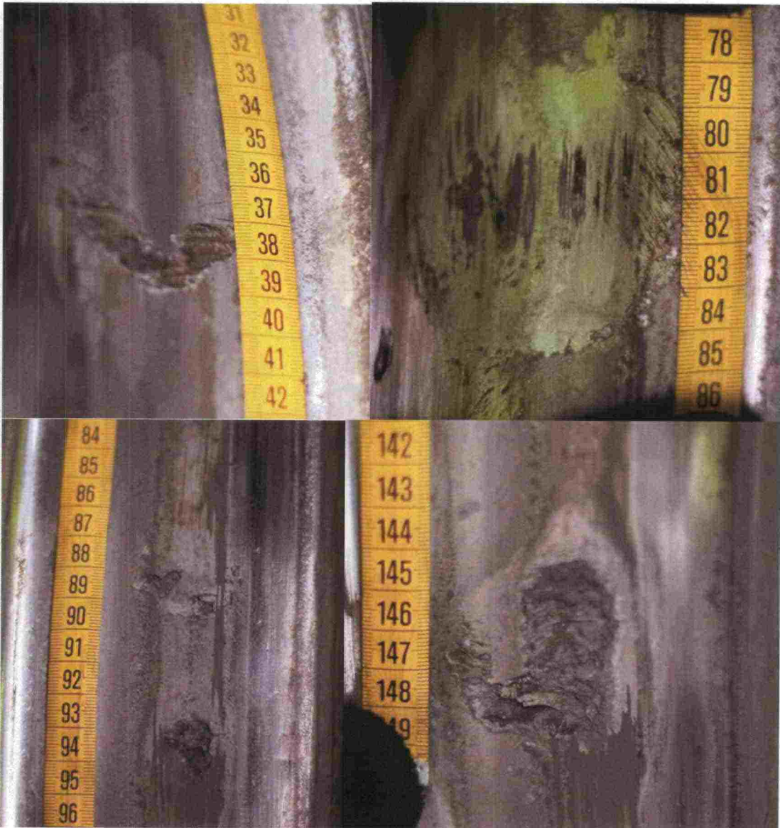
Kuva 53. Vaunun viisi kolmannen akselin pyöräviat
