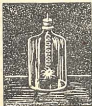
Kuva 24. Rautalangan palami- nen hapessa,
