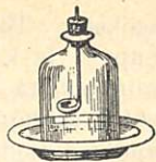
Kuva 25. Polttokauha, jolla fosfori poltetaan hapessa.
