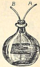
Kuva 35. Lasipullo, jonka avulla näytetään puhtaan ja uloshengitetyn ilman vaikutus kalkkiveteen.
