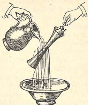
Kuva 12. Höyryä täynnä oleva astia ja sen puristuminen kokoon höyryn tiivistyessä.
