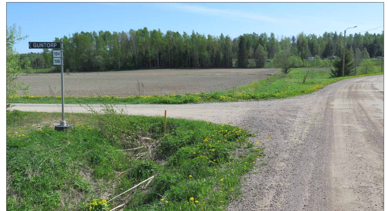
Kuva 36. Näkymä Karlbergintieltä kohti kantatietä. Hylättyssä Karlbergintien eritasoliittymävaihtoehdossa tälle ilmeisen huonosti kantavalle peltoalueelle olisi täytynyt rakentaa korkea pengerrystä sivutien ja ramppien kohdalle.
