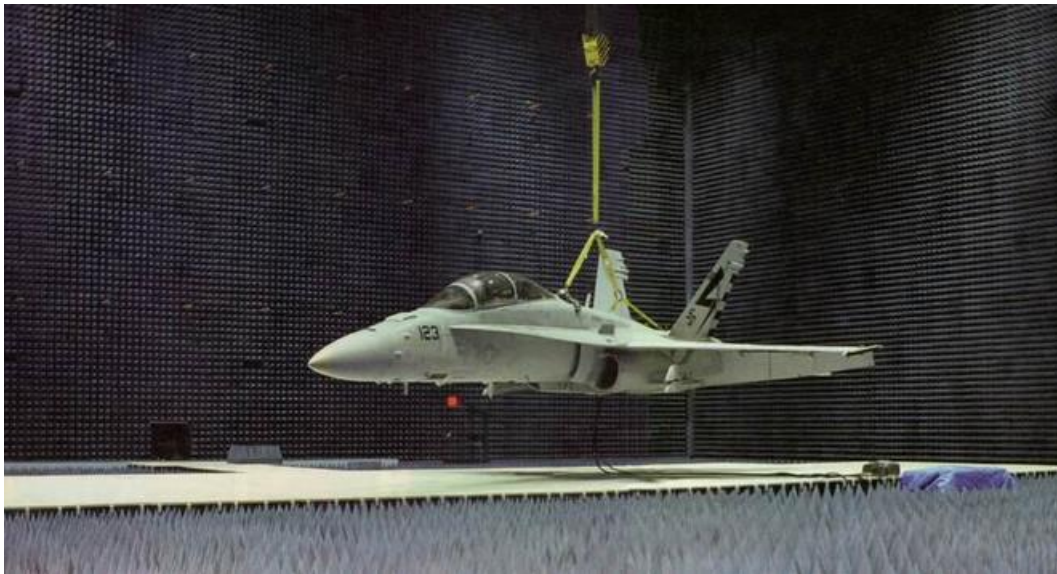
Kuva 11. Hävittäjän häiveominaisuuksien mittaamista laboratorioissa [33].
