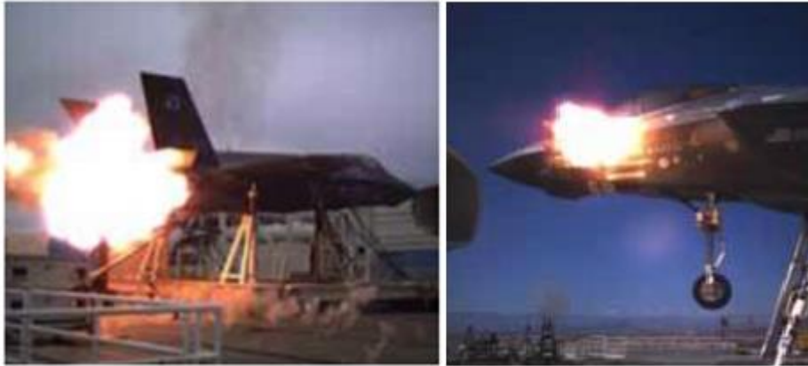
Kuva 12. F-35:n kriittisten järjestelmien haavoittuvuuden testaus ammuntakokein [12].
