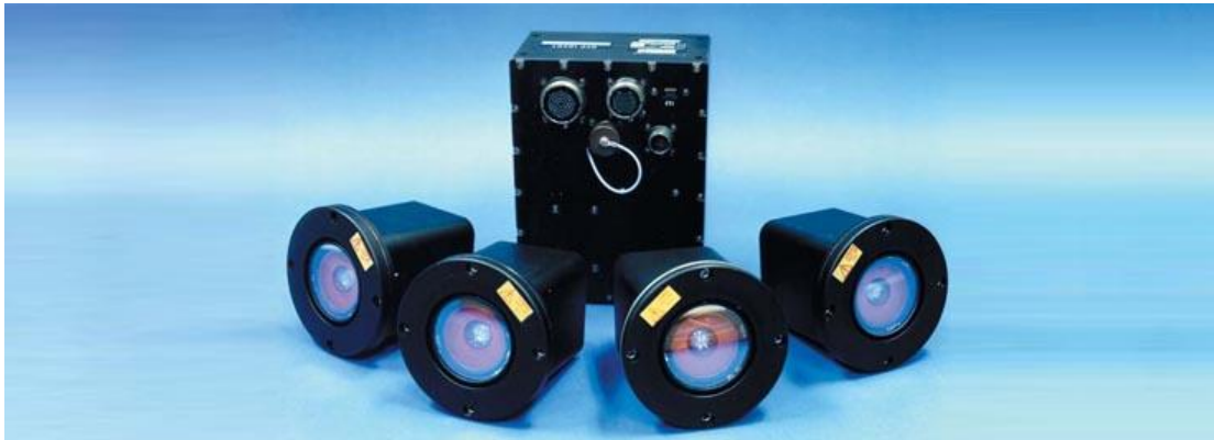
Kuva 15. AN/AAR-54(V) passiivinen UV-alueen ohjusvaroitin [35].
