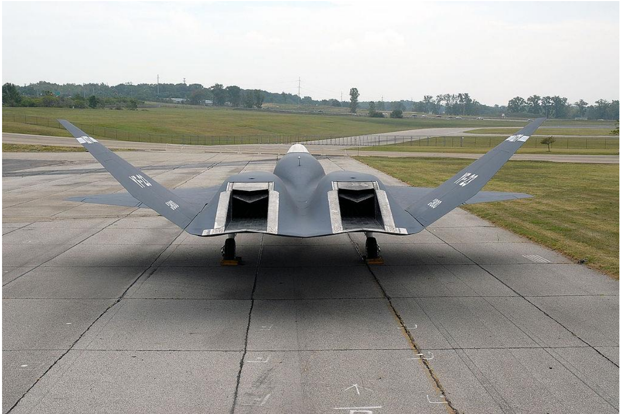
Kuva 20. Northrop YF-23:n lämpöherätettä pienentävät suihkusuuttimet [54].
