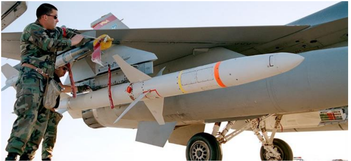
Kuva 22. AGM-88 HARM -tutkasäteeseen hakeutuva ohjus [41].
