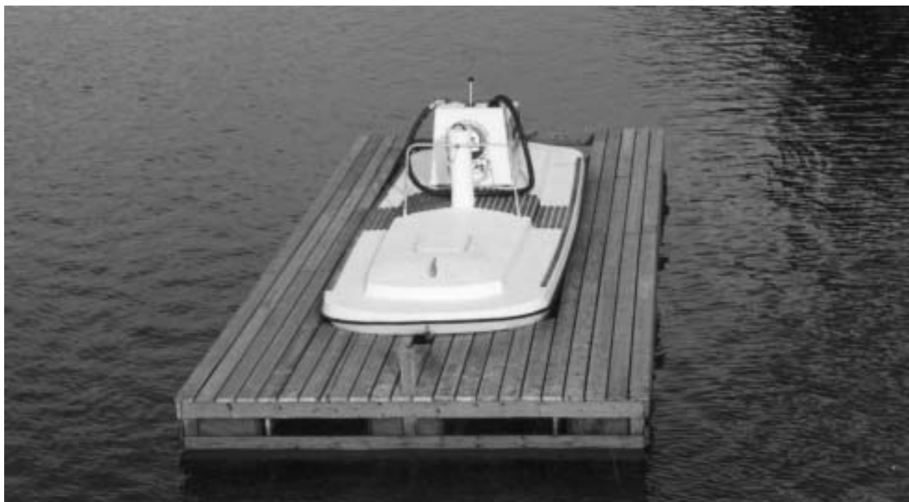
Ponttonirakennelmalla varustettu kelluva imutyhjennyslaite. Kuva: PSS ry
