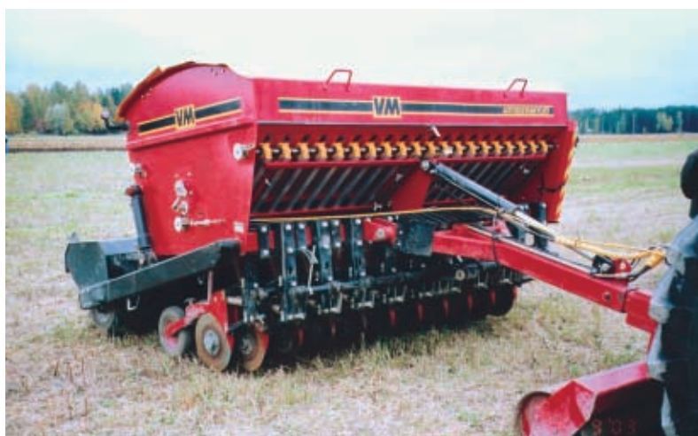
Bild 9. En bearbetningsmaskin för ytlig bearbetning av jorden och en såmaskin för äkta direktsådd demonstreras på en mässa år 2003. Bilder: Mikko Jaakkola.
