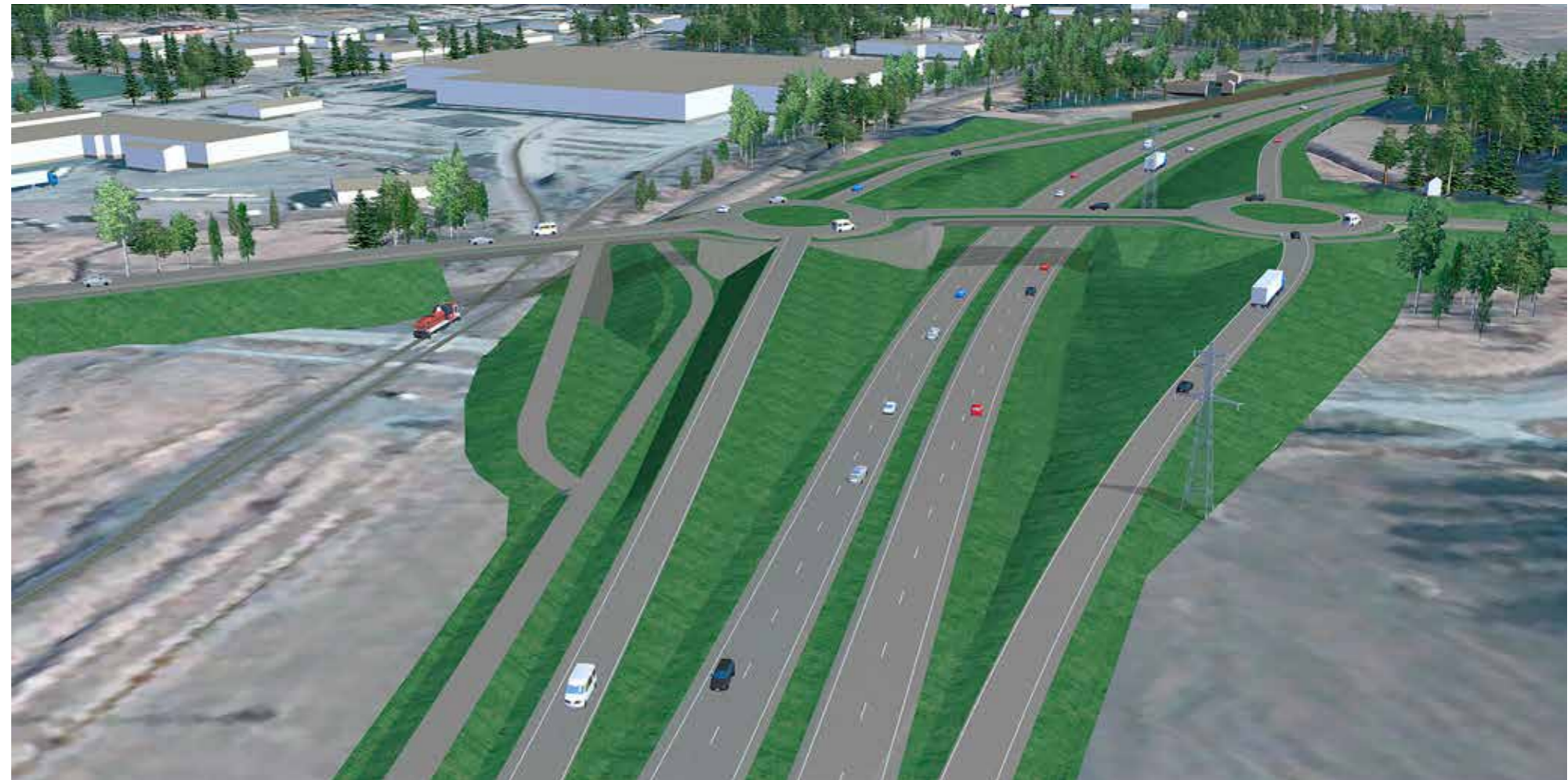
Kuva 75. Havainnekuva Ruonan eritasoliittymästä Naantalin vaihtoehdosta 4 idästä päin katsottuna. Eteläisempi kiertoliittymä vaatii nykyisestä poikkeavia tukirakenteita.
