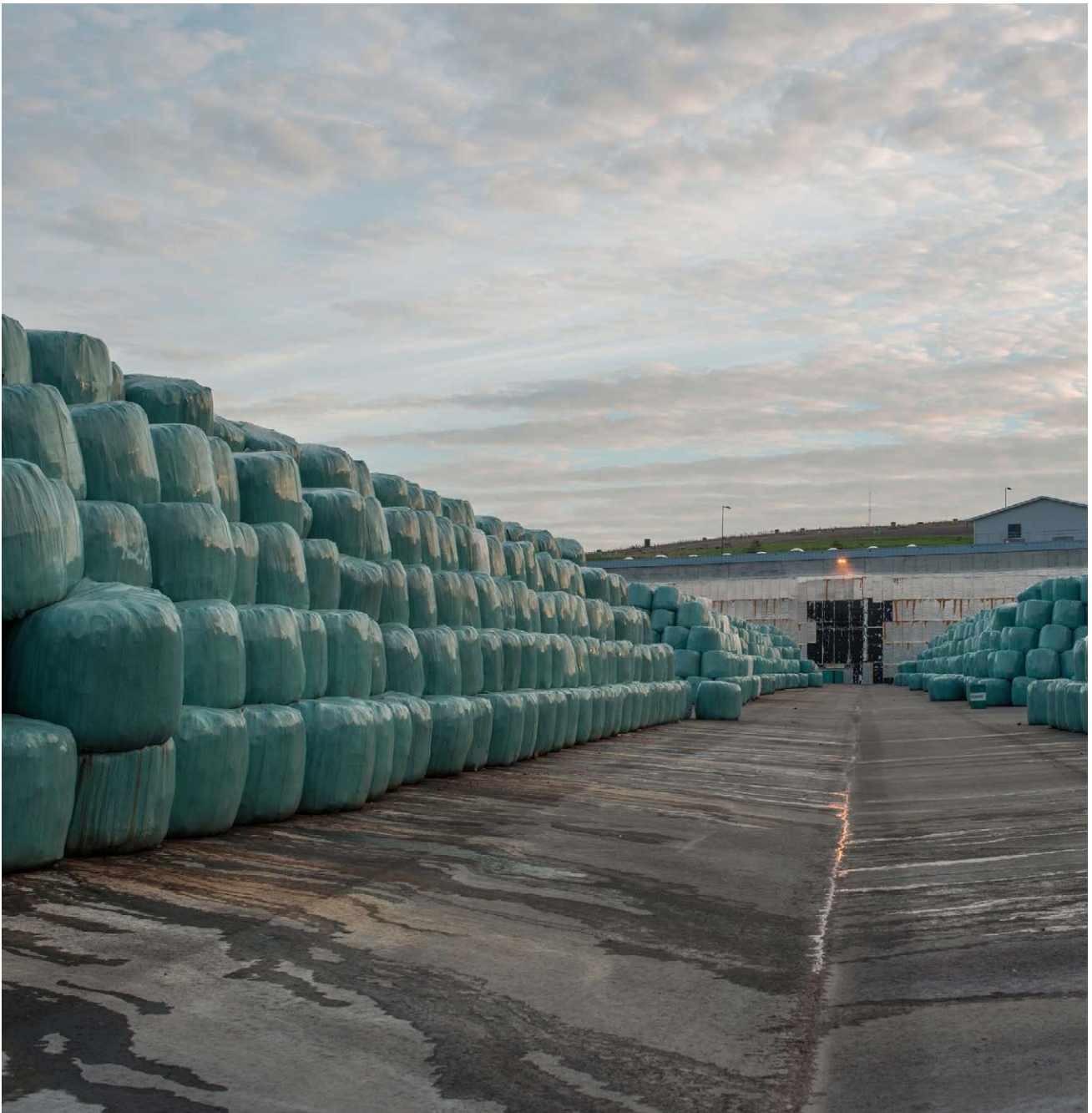
Kuva 20. Paalatun, jätevoimalaan menevän sekajätteen varastointia. Kuva: HSY/Juuso Westerlund
