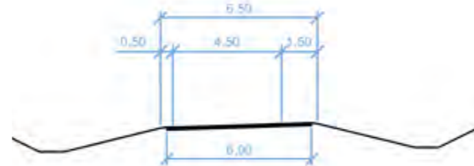
Kuva 26: Peruspoikkileikkaus eritasoliittymien rampeilla
