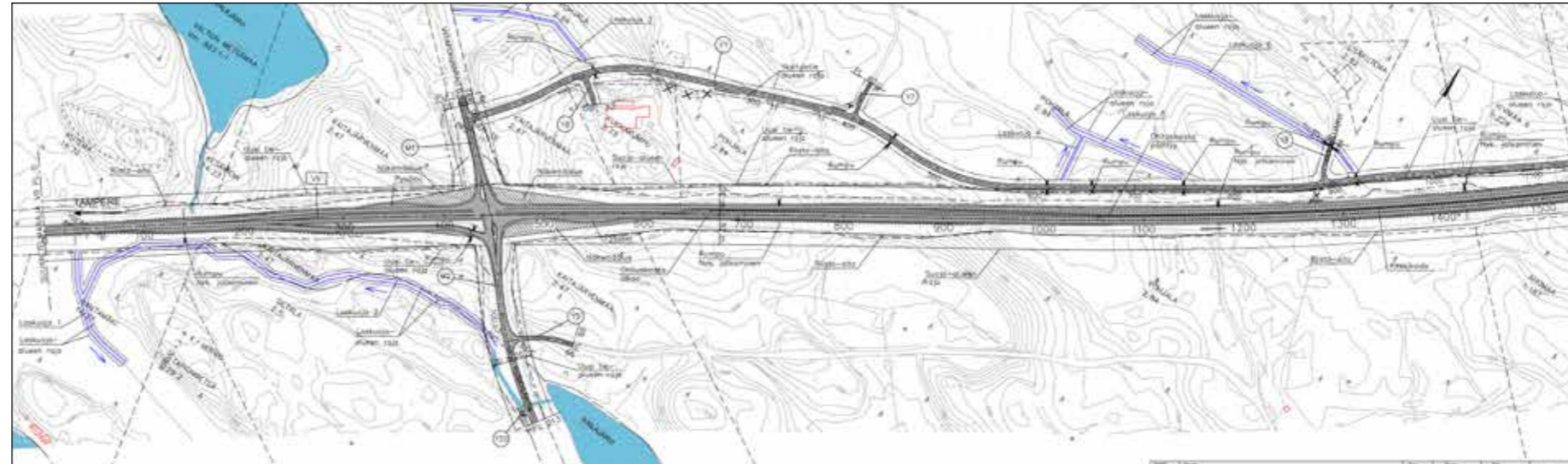
Kuva 67. Ote tiesuunnitelmasta Suinula–Käpykangas: Suinulan eritasoliittymä ja ohituskaistajakson päät.
